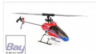
Der mCP X verfügt über ein voll funktionstüchtiges Flybarless System. AS3X und CCPM Mechanik erlauben es, mit diesem Hubschrauber ein anspruchsvolles Kunstflugprogramm inklusive Rickenflug zu zelebrieren.
