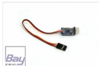
Die Latenzzeit beträgt 3 Sekunden. Das bedeutet, dass die Reifen in 3 Sekunden schließen daher benötigt der Sequencer ein elektrisches Einziehfahrwerk welches schneller als 3 Sekunden ist andernfalls schließt die Tür bevor das Fahrwerk zurück im Tank ist.
