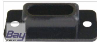
Einbaurahmen für die grünen oder roten Hochstromstecker, z.B. für die Tragflächenverbindung. Einfach in die Fliche und den Rumpf schrauben, Multiplexstecker einführen und mit einem Tropfen Sekundenkleber sichern.
