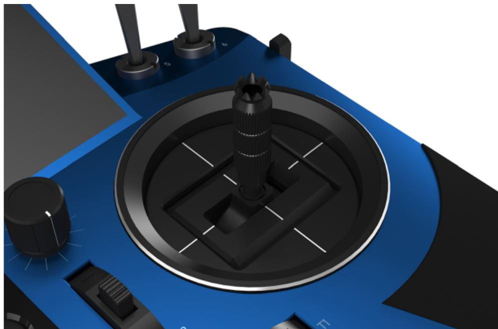
Die hoch bearbeiteten Aluminium-Kreuzknöpfe sind auf 10 Kugellagern montiert. Die Bewegung der Knöpfe wird von Hall-Sensoren anstelle von herkömmlichen Potentiometern erfasst. Das macht die Steuerung präziser und zuverlässiger. Sie können die Knöpfe auch an Ihre eigenen Vorlieben anpassen. Sie können die Länge der Knöpfe ganz einfach einstellen, die Kreuzknöpfe um bis zu 8° drehen und ihren Bewegungsbereich auf 45° bis 60° begrenzen.
