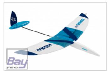
Das Leitwerk besteht aus CNC-geschnittenen Balsabrettern und Carbonverstärkungen. Das Höhen- und Seitenruder werden von Servos angesteuert, die sich im Rumpf befinden, wobei Stahldraht-Schubstangen durch den Heckausleger laufen.
