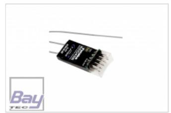
HINWEIS: Beim Einsatz von 2S LiPo-Akkus als Empfngerakku, mssen auch die angeschlossenen Servos fr diese Spannung ausgelegt sein. Der Empfnger besitzt keinen internen Spannungswandler fr die Servospannung!
