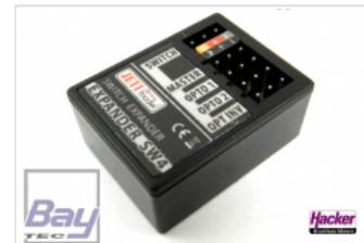
**Anwendungsbeispiel:** ein RC Switch oder ein magnetischer Schaltgeber steuert über den Expander SW4 eine CentralBox und einen SPS 20 (z.B. für Sonderfunktionen) an. Beide Gerte werden dann gemeinsam EIN/AUS geschaltet. Auch wenn mehrere Central Boxen in einem Grossmodell eine Anwendungsmöglichkeit.
