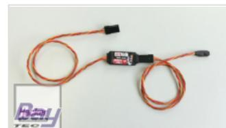
Der DUPLEX 2.4EX Sensor MRPM-Hall dient zur Drehzahlmessung per Hallsensor. Dazu wird auf dem zu messenden, sich drehenden Teil ein Magnet befestigt. Der Hallsensor erfasst berührungslos die Drehzahl. Er eignet sich daher bestens auch für Messungen an Schwungscheiben, Getriebezahnrädern, usw.
