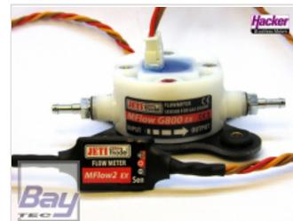
Der MFlow2-Gas ist fr Modelle mit "Benziner"-antrieb geeignet.
