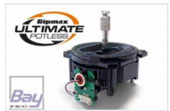
Verbunden mit der neuen Technik ist auch die Umrstung der bisherigen Knppelaggregate auf hohle Knppelachsen bei Pultsendern. So gelingt die Nachrstung von Knppelschaltern im Handumdrehen, ohne dass diese Arbeiten im Service durchgefhrht werden mssen.
