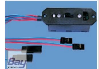
Alle Teile der Weiche sind auf einer Platine verl?tet. Die Kabel zur Weiche sind auf breiten L?t-Pads knickfrei verl?tet und mit einem speziellem Sicherungsklebstoff gegen jegliche Vibrationen gesch?tzt. Die nach au?en f?hrenden Kabel werden durch einen Schrumpfschlauch mit Innenverklebung ebenfalls gegen Vibrationen und Abknicken gesichert. Seit dem Jahre 2002 wird dieses Produkt unver?ndert in tausenden Modellen mit gro?em Erfolg eingesetzt.
