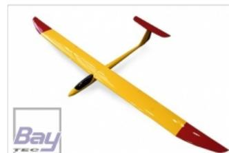
Spannweite 2,60m , Lnge 1,22 , Gewicht ca 1,0 Kg , Profil MH 32 ,
