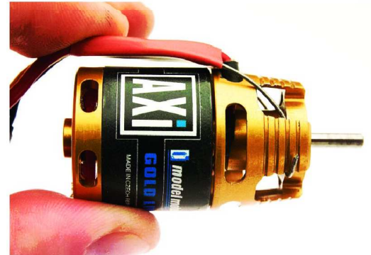
Takto to má vypadat. Pružinka odtlačuje kabely od rotačního pláště motoru a zamezuje jejich prodrnění. This is what it should look like. The spring pushes the cables away from the rotating casing and prevents them from abrasion.
