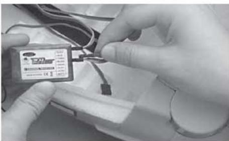
15) Stecken Sie die Speedcontroller-Kabel in den THR-Kanal des Empfängers.
