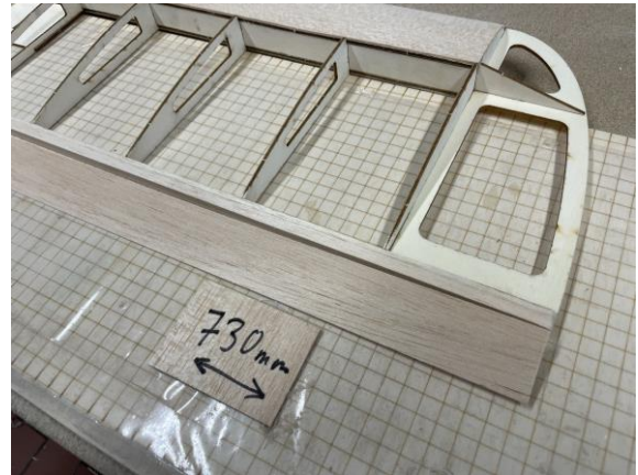
Untere Kante ca. 30 Grad anschleifen
