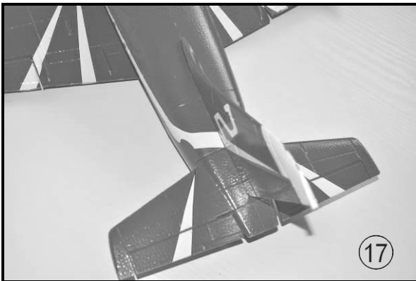
Bild 17 – Kleben Sie das Seitenleitwerk in den Rumpf. Achten Sie darauf, dass es gerade zum Rumpf ausgerichtet ist.
