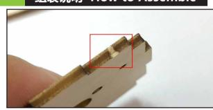
注意:木件用美工刀从板材上取下,各连接点用快干胶定型,用白乳胶固定。
