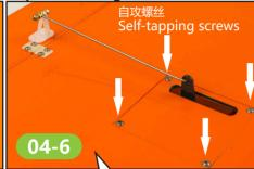
钢丝连杆Z型一头连接舵臂,然后连杆垂直机翼确定出 舵角位置,然后安装舵角。在舵角上安装快装接头, 快装接头锁定连杆。
