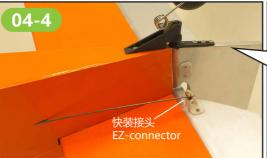
连杆从机身尾部预留槽导出,根据连杆位置确定出舵角位置,然后安装舵角。 在舵角上安装快装接头,快装接头,快装接头,快装接
