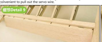
副翼安装到机翼, 合页插入机翼预留槽内,用快干胶粘固,并保持副
