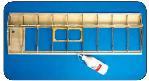
Bestreichen sie auf der Tragflächenoberseite sämtlichen vorderen Rippen, die Hilfsleiste, den Hauptholm sowie den hinteren Holm mit Leim.
