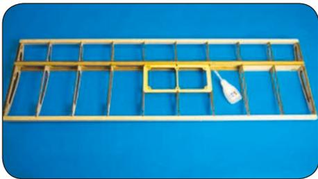
Drehen Sie die Tragfläche, so dass die Tragflächenunterseite nach oben schaut. Positionieren Sie W11 (Servoschacht) an der Tragfläche und kleben es mit Sekundenkleber fest.
