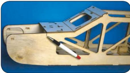
Platzieren Sie nun die Kabinenabdeckung vorne auf dem Rumpf und markieren das Ende wie im Bild oben gezeigt.
