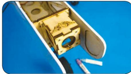
D Kleben Sie die Motorhalterung mit Epoxi-Kleber vorne auf die Spante.
