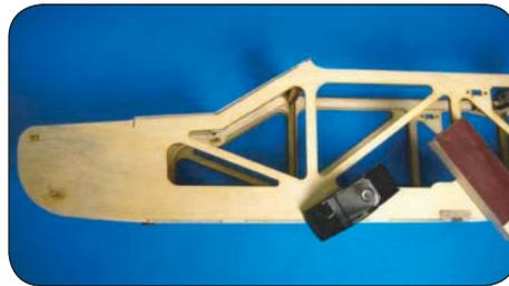
Schleifen Sie die Kanten am Rumpf rund (3 mm) ab und verschleifen Sie auch die Fläche bündig.
