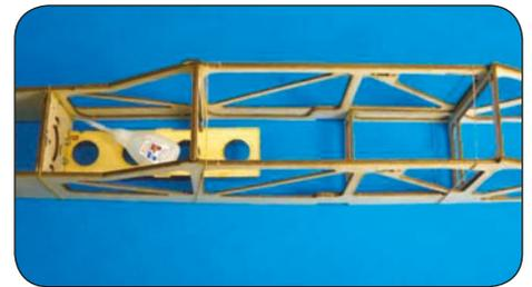
Wenn alles exakt ausgerichtet ist, können die Spanten (F3/4, F6, und F8) an den Kontaktpunkten verklebt werden.
