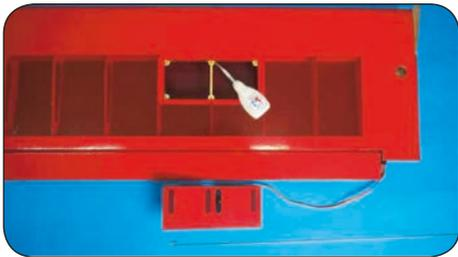
Um ein Ausreißen der Schrauben zu verhindern, ist es empfehlenswert, nach dem Vorbohren etwas Sekundenkleber in die Bohrungen zu geben.
