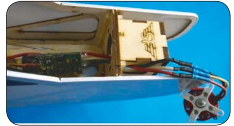
E Führen Sie die Kabel des Reglers durch die Aussparungen seitlich durch den Motorhalter und verbinden Sie diese mit dem Motor.
