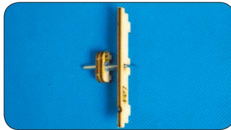
Montieren Sie F28 auf F27, wie oben gezeigt. Zwischen F28 und F27 müssen Sie eine kleine Feder auf den Verriegelungsstift aufstecken.
