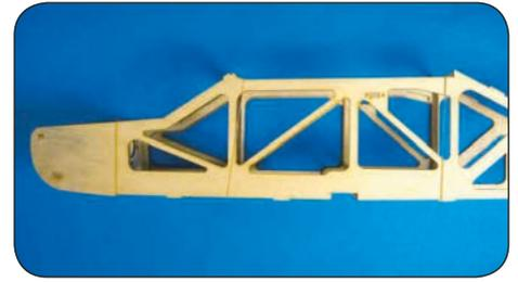
Positionieren Sie nun das zweite Seitenteil (F1/F2L) am Rumpf und achten auch hier auf eine korrekte Ausrichtung. Sichern Sie den Rumpf mit Gummibändern, damit die Teile während nicht verrutschen.
