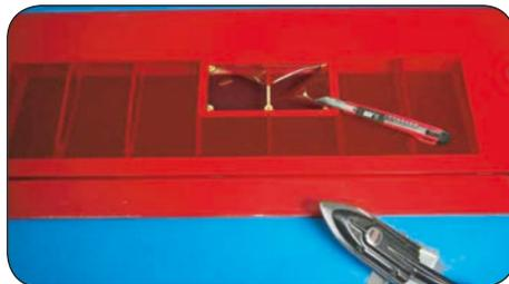
Entfernen Sie die Folie im Bereich der Servoschächte und bügeln die Ränder mit einem Folienbügelleisen fest.
