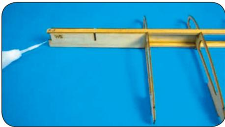
Verkleben Sie das Bauteil W5 links am Ende des Hauptholms, wie in der Abbildung gezeigt.
