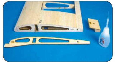
Positionieren Sie die Verstärkungsplatten (W18/17) und die Wurzelrippenverstärkung (W19) an der Tragfläche und verkleben sie mit dieser.
