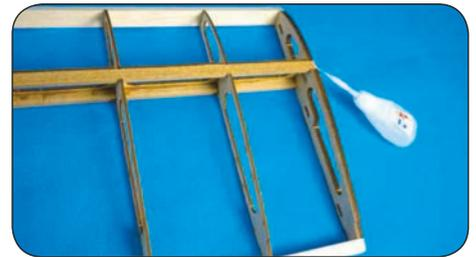
Befestigen Sie nun W10 mit genügend Sekundenkleber außen an der Tragfläche.
