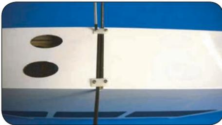
Das Hauptfahrwerk wird in die Nut am Rumpfboden gedrückt und mit den beiliegenden Laschen festgeschraubt.
