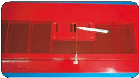
Positionieren Sie das Ruderhorn auf dem Querruder der Tragfläche. Befestigen Sie den Gabelkopf am Servohebel und markieren die benötigte Länge des Gestänges. Sollten Sie ein Servo für die Landeklappe benötigen, wiederholen Sie diesen Arbeitsschritt.
