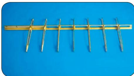
Stecken Sie die Tragflächenrippen W8 - W9 (Reihenfolge siehe Plan) auf den Holm (W2/W3 Hauptholm) auf. Nach Aufsteckung der Rippen auf die Holme richten sie diese mit Hilfe eines Winkel im 90° Winkel zum Hauptholm aus und verkleben sie mit Sekundenkleber.
