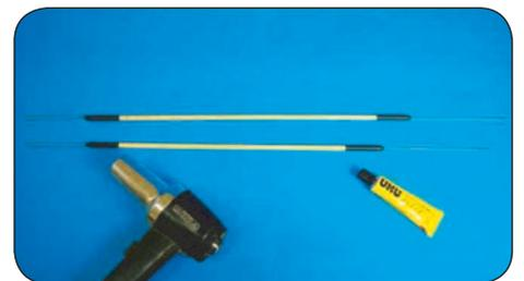
Schieben Sie Schrumpfschläuche auf die Verbindungen und lassen sie mit einem Heißluftföhn schrumpfen.
