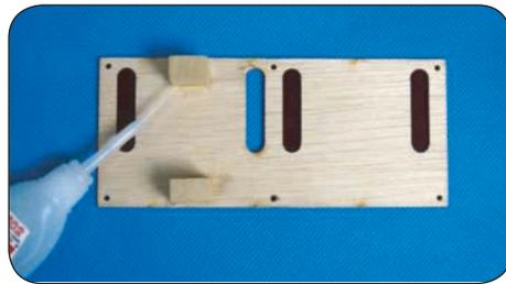
Kleben Sie die zwei Hartholzblöcke auf die Servoabdeckung (diesen Bauschritt können Sie auf dem beiliegenden Bauplan einsehen).
