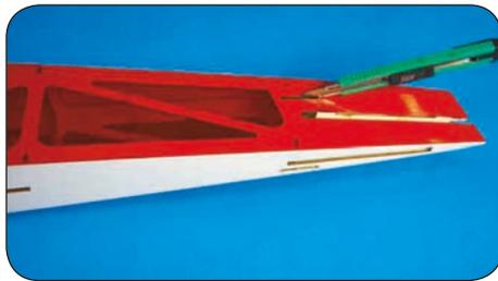
Schneiden Sie die Schlitzte für das Höhen- und Seitenruderge- stänge aus.
