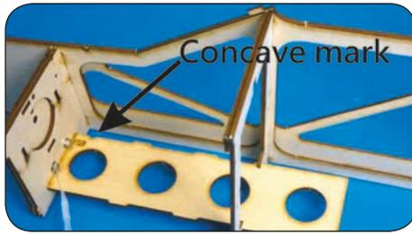
Bitte achten Sie darauf, dass die kleine Aussparungen an F13 und an F3/4 auf der gleichen Seite sind und zu F2R zeigen. Wenn F13 korrekt positioniert ist, kann sie nun mit F3/4 verklebt werden.
