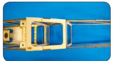
Stecken Sie das hintere Kabinfenster F21 auf den Rumpf auf und sichern es mit Sekundenkleber.
