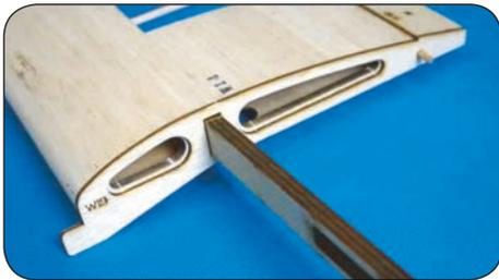
Stecken Sie nun den Tragflächenverbinder (W29) in die Aussparung der Wurzelrippe. Sollte dies nicht perfekt passen, schleifen Sie es mit Schleifpapier passend.
