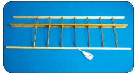
Richten Sie die Tragflächenrippen an W4R aus und drücken Sie in die vorgesehenen Aussparungen. Kleben Sie nun die Tragflächenrippen mit etwas Klebstoff an. (W4L wird für die linke Tragfläche benötigt).
