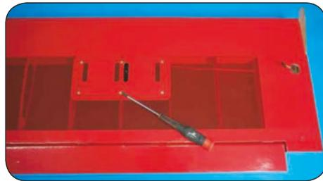
Führen Sie das Servoanschluskabel von der Kabeldurchführung durch die Tragfläche zum Servoschacht. Bauen Sie die Servoabdeckung in die Tragfläche ein.
