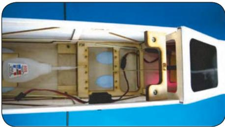
Um ein Ausreißen der Schrauben zu verhindern, ist es empfehlenswert, etwas Sekundenkleber in die Bohrungen für die Servos zu geben.
