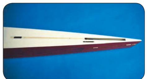
Entfernen Sie auch die Folie für das Seitenleitwerk auf dem Rumpf. **Achtung! Schneiden Sie nicht in das Holz!** Ziehen Sie nun die Folie ab.
