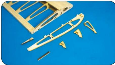
Für die Flügelspitze entnehmen Sie W21, W22, W23, W24, W25 und W25-1 und legen Sie auf die Arbeitsfläche. Verkleben Sie die Teile miteinander und kleben diese an die äußere Wurzelrippe der Tragfläche.
