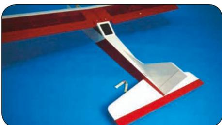
Streichen Sie Epoxy-Kleber auf die Klebeflächen (die Flächen ohne Folie) und stecken die Leitwerke wieder in den Rumpf. Richten Sie die Leitwerke exakt aus, wie im Plan auf Seite 13 gezeigt.
