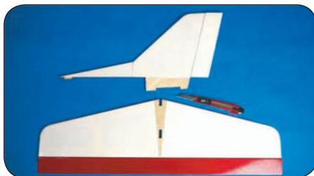
Entnehmen Sie das Höhen- und Seitenleitwerk dem Rumpf und ritzen vorsichtig die Folie, entlang der Markierung mit einem Lineal ein. **Achtung! Schneiden Sie nicht in das Holz!** Ziehen Sie nun die Folie ab. Statt eines Messers können Sie auch einen Lötkolben benutzen.
