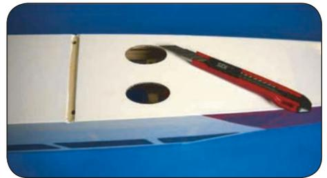
Schneiden Sie die Folie über der Nut für das Fahrwerk und die Kühlungs- schlitzten unten am Rumpf aus.
