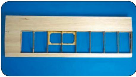
Legen Sie die Beplankung auf die Oberseite der Tragfläche und achten Sie darauf, dass die Beplankung korrekt ausgerichtet ist.
