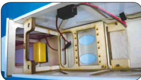
B Installieren sie den Empfängerakku und das Schaltkabel.
