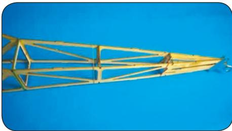
Platzieren Sie die Spanten (F9/F10 und F11) wie abgebildet im Rumpf und stabilisieren Sie das ganze zwischen den einzelnen Spanten mit Gummibändern. **Achtung! Noch nicht verkleben!** Achten Sie darauf, dass die Spanten richtig ausgerichtet sind.
