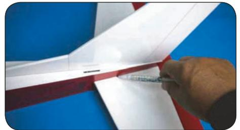
Richten Sie das Höhenleitwerk genau in einem 90° Winkel zum Seitenleitwerk aus und markieren links und rechts die Folie.
