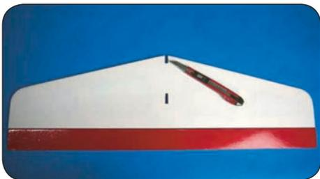
Markieren Sie die beiden Ausschnitte für das Seitenleitwerk auf der Oberfläche des Höhenruders. Schneiden Sie die Folie über den Aussparungen mit einem Messer auf.
