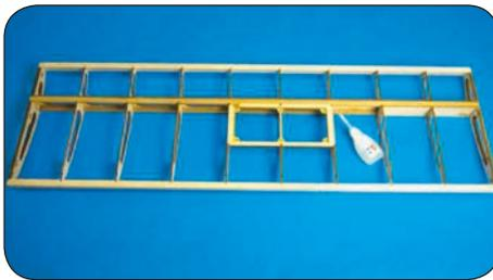
Kleben Sie W12 passgenau auf die Oberfläche von W11 auf.
