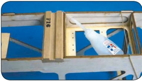
Stecken Sie die Fahrwerkshalterung unten in die dafür vorgesehene Aussparung am Rumpf ein. Wenn die Halterung korrekt sitzt, können Sie diese mit Sekundenkleber einkleben.
