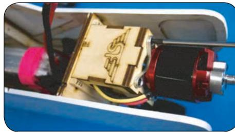
G Befestigen Sie ein Stück Klettband so am Servobrett, dass der Akku damit umwickelt werden kann. Schließen Sie den Regler am Motor an und fixieren Sie ihm ebenfalls mit Kabelbinder am Akkubrett. Überprüfen Sie die Laufrichtung vom Motor, dieser muss sich gegen den Uhrzeigersinn drehen.
