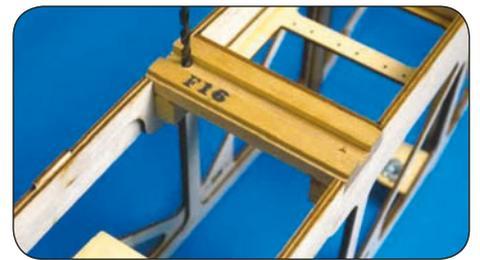
Bohren Sie, wie im beiliegenden 1:1 Bauplan gezeigt, links und rechts ein 4,2 mm Loch in die Fahrwerkshalterung (F16).
