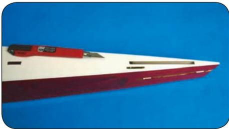
Schneiden Sie die Folie, hinten am Rumpf, über den Schlitzten für das Höhen- und Seitenleitwerk aus.
