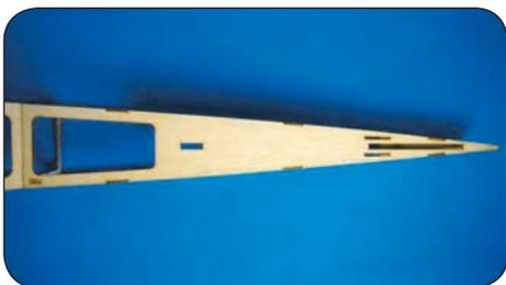
Wie oben abgebildet, wird die obere Beplankung F22 auf die Oberseite vom Rumpf aufgeklebt.
