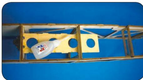
Drehen Sie den Rumpf um, so dass die Unterseite vom Rumpf oben ist. Tragen Sie am Kontaktpunkt von F6 und F13 Klebstoff auf.
