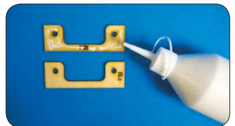
Platzieren Sie für die Tragflächenbefestigung 2 x F18 auf der Arbeitsfläche, bestreichen eines mit Leim und verkleben sie miteinander.
