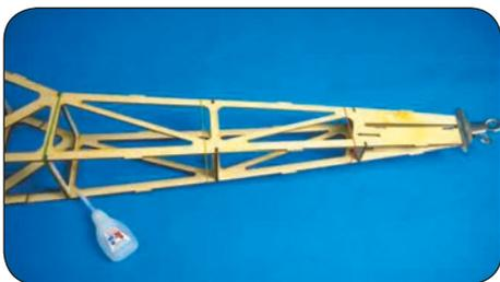
Wenn die Spanten F9, F10 und F11 genau ausgerichtet sind, könne auch diese an den Kontaktpunkten verklebt werden.
