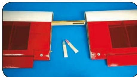
Nehmen Sie den Tragflächenverbinder (W29) und bestreichen ihn beidseitig mit Epoxy-Kleber. Bestreichen die Aufnahmetaische für den Tragflächenverbinder und fügen Sie die Teile zusammen (Sie können auch die Stoßkanten der Tragflächen mit Epoxy-Kleber bestreichen, können dann die aber die Tragfläche z.B. zum Transport nicht mehr trennen).
