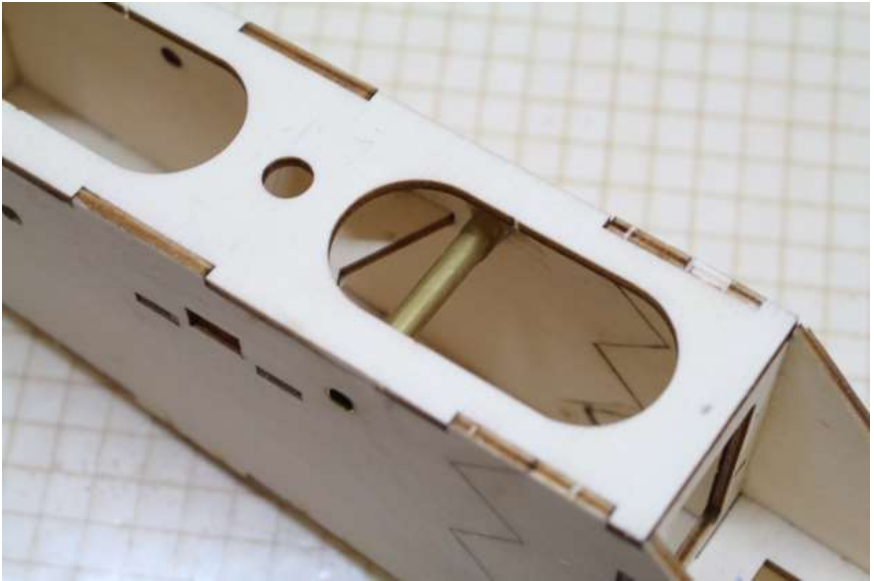
Messingrohr ( \text{\O}6 \times 5 , 51 mm lang) in Rumpf mit 5-min-Epoxy einkleben
