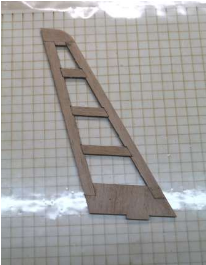
Rahmen der Dämpfungfläche aus den Teilen (K1, K3, K2, K4) zusammensetzen, verleimen & Stege einleimen
