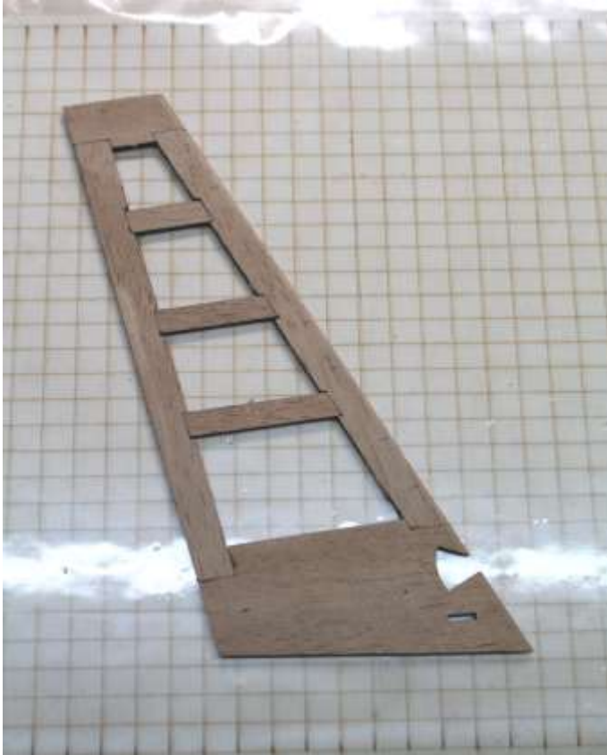
Rahmen des Seitenruders aus den Teilen (K6, K9, K8, K7) zusammensetzen und verleimen und Stege einleimen
