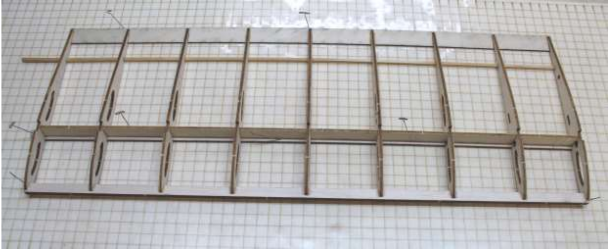
Nasenleiste (D1) einfädeln und verkleben
