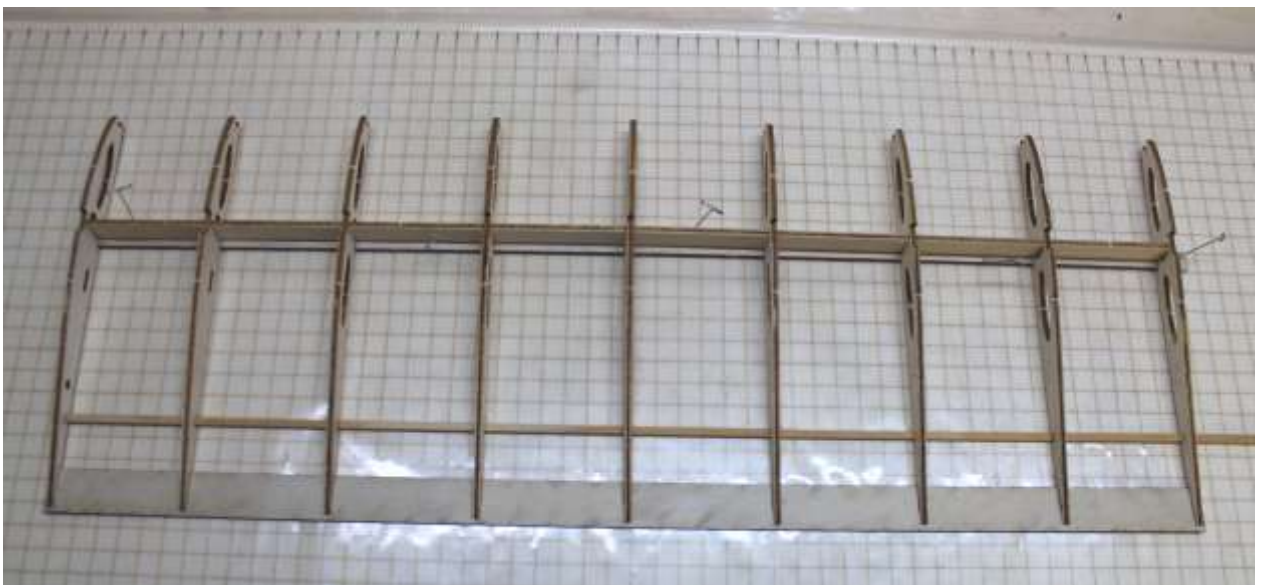
Endleiste (C1) an Rippenenden schieben und verkleben
