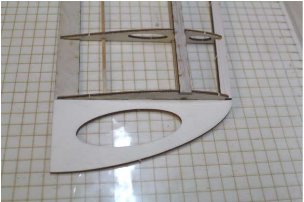
Randbogen (B3) an Rippe (A11) verleimen
