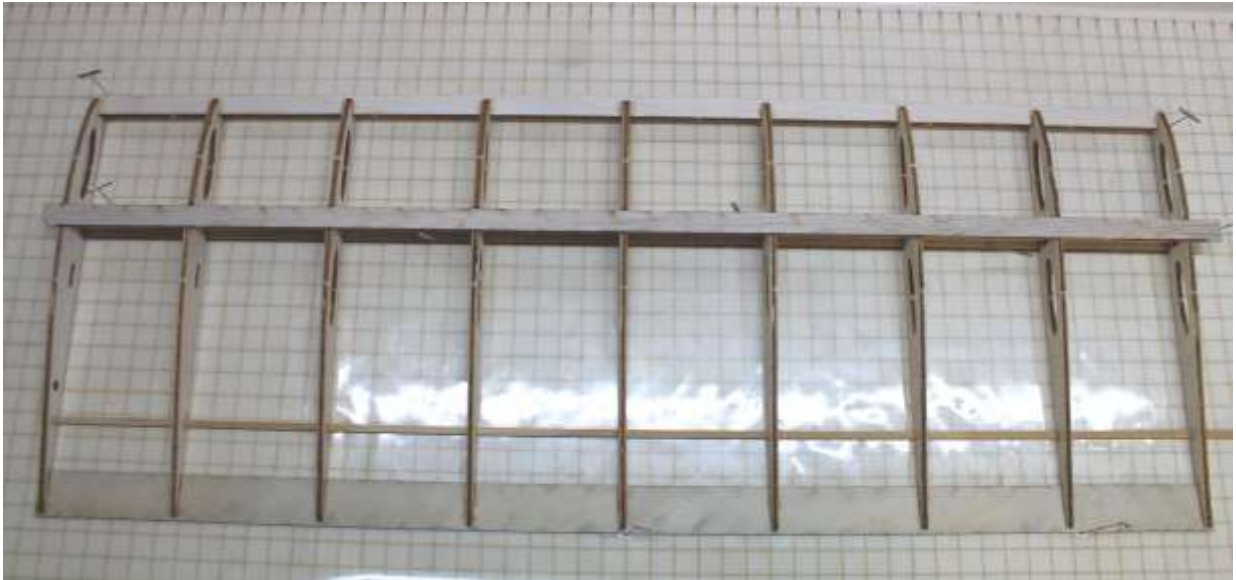
Oberer Hauptholm (Balsa 10×3×510mm) einkleben
