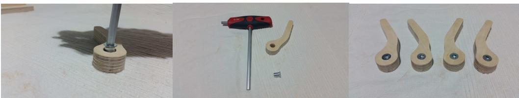
5. Jetzt müssen die Ohren am Gestell mit den Flügelschrauben montiert werden. Hierbei darauf achten, dass die Ohren nach innen zeigen. Unter die Flügelschrauben müssen die Unterlegscheiben gelegt werden um das Holz beim Verspannen zu schützen
