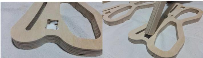
3. Den Vorgang aus Punkt 2 für das zweite Seitenteil wiederholen und den Ständer komplett verbinden. Dabei darauf achten, dass die Teile mit reichlich Kraft zusammen gedrückt werden, um so die Parallelität der Seitenteile sicher zu stellen.
