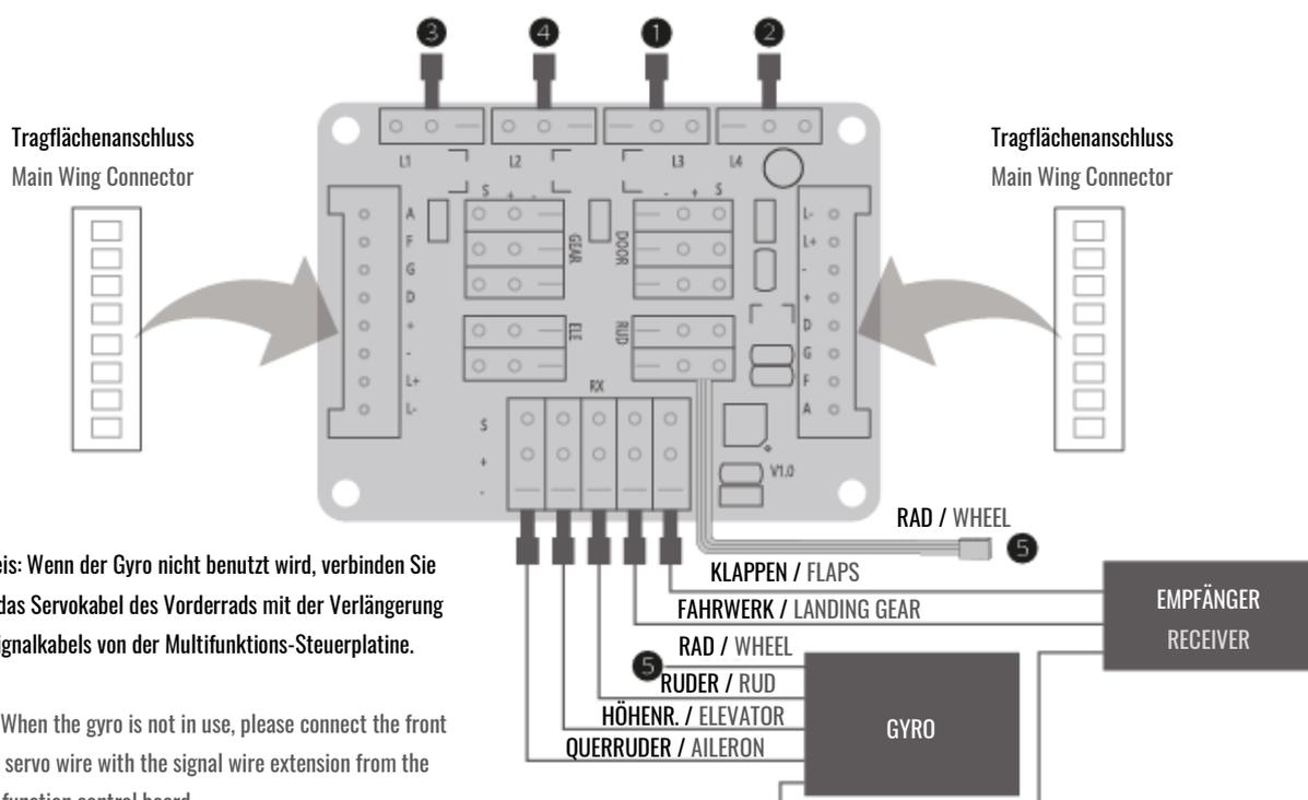
**Hinweis:** Wenn der Gyro nicht benutzt wird, verbinden Sie bitte das Servokabel des Vorderrads mit der Verlängerung des Signalkabels von der Multifunktions-Steuerplatine.
