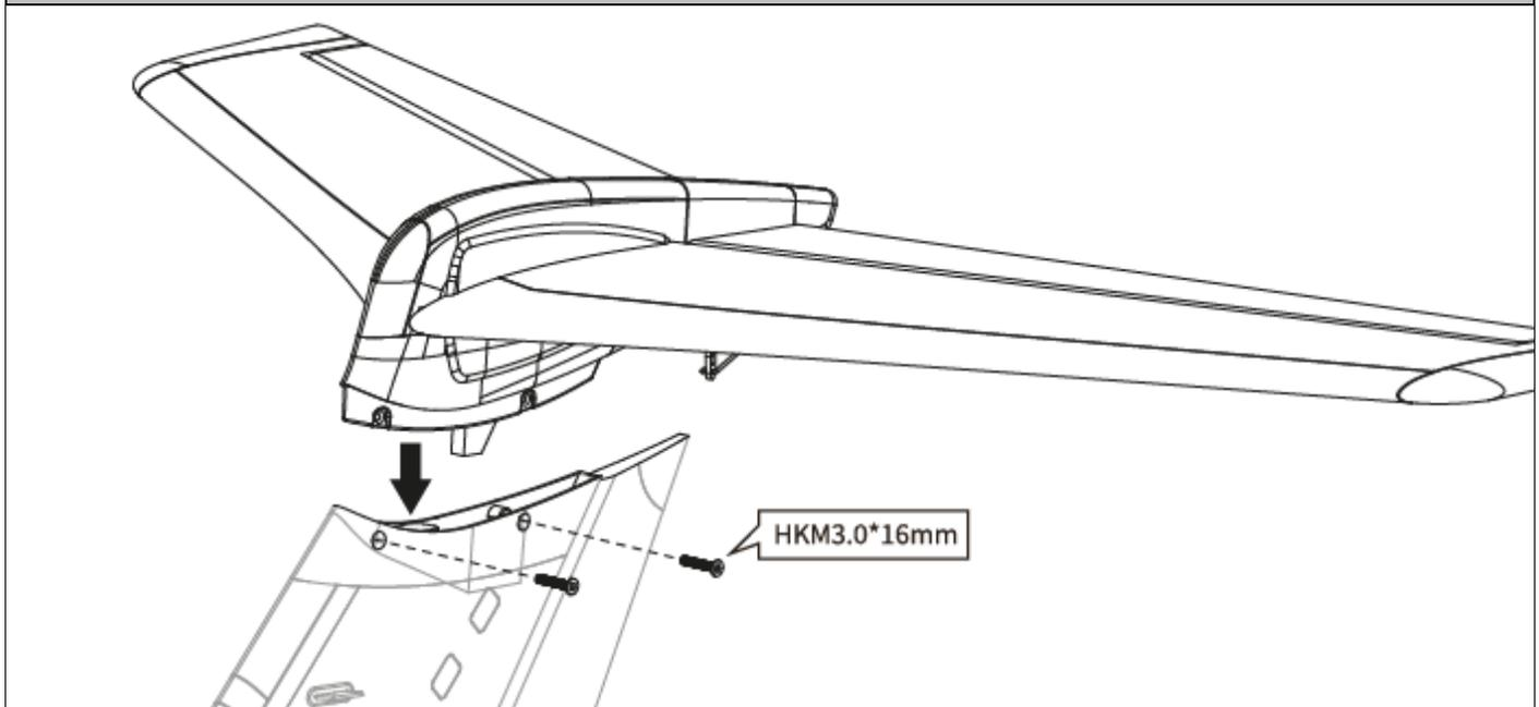
Setzen Sie das Höhenleitwerk in den Schlitz des Leitwerks ein und befestigen Sie es mit den mitgelieferten Schrauben.
