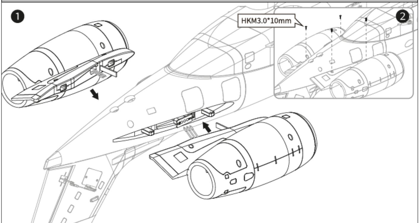
1. Stecken Sie die Motorkabel (in der Reihenfolge rot, gelb, schwarz) in den Stecker und befestigen Sie die Gondeln in den Schlitzen wie gezeigt.
