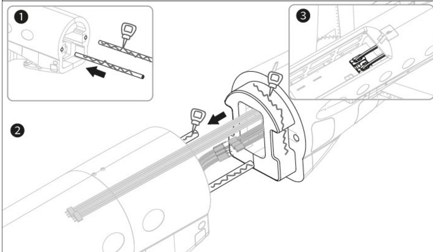
1. Tragen Sie etwas Kleber auf die Holme auf und stecken Sie sie in die Schlitz des vorderen Rumpfes.
