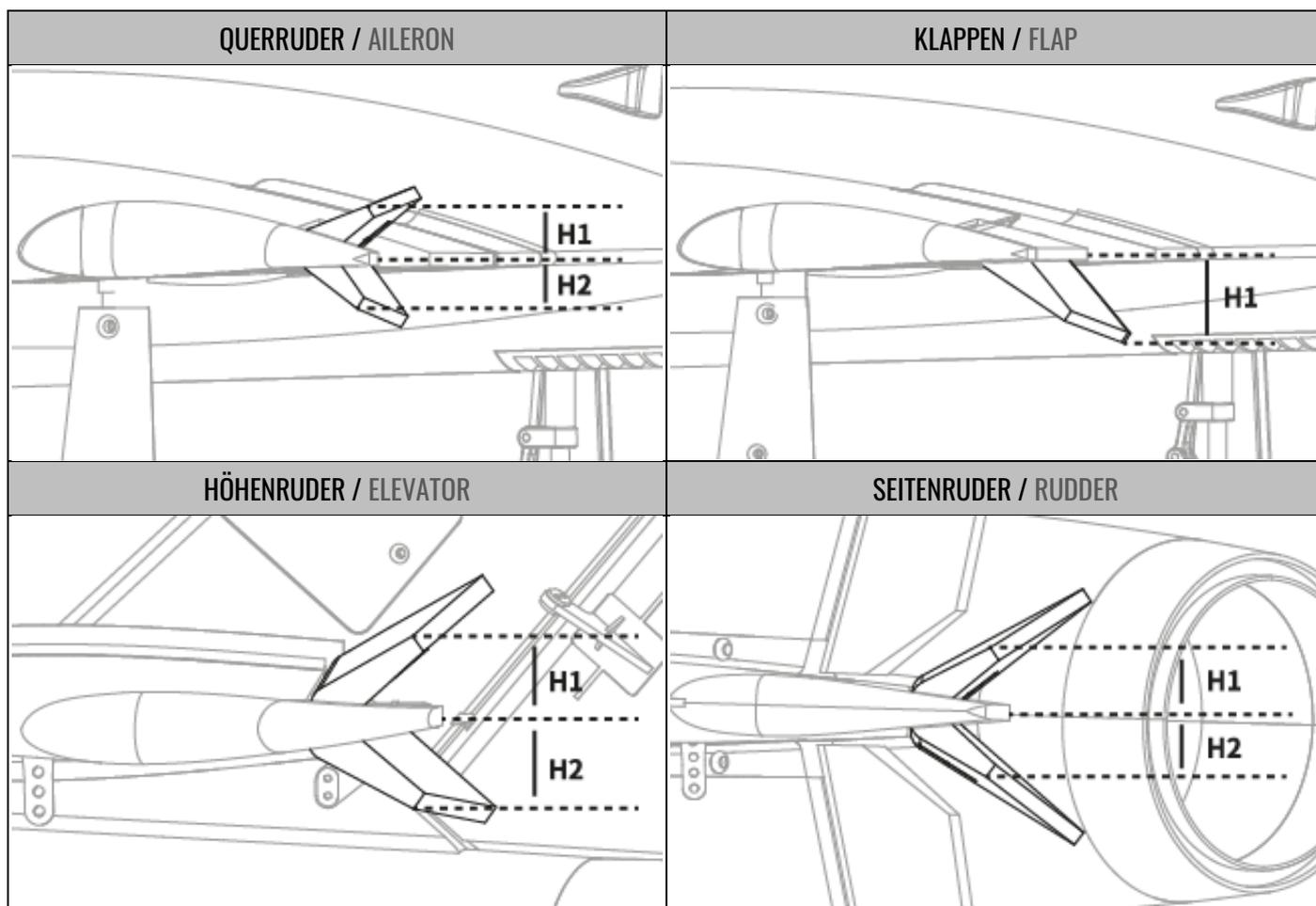
**Hinweis:** Wenn die Klappen losgelassen werden, geht das Flugzeug nach oben, so dass für eine gute Landung eine gemischte Höhenrudersteuerung erforderlich ist. Sie erfordert eine Absenkung um 1 mm für die hohe Dual-Rate-Klappe und um 2 mm für die niedrige Dual-Rate-Klappe.
