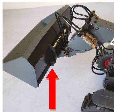
**6.** Montieren Sie die Gabel auf die gleiche Weise wie die Schaufel (es ist besser, das männliche Ende des Schnellspannzylinders nach oben zu versetzen, damit die Ecken des linken und rechten Rohrs gleich sind).
