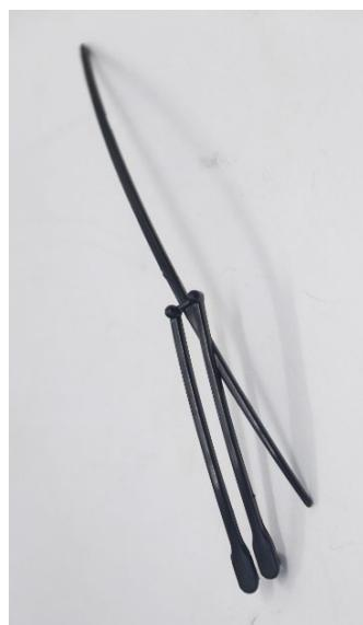
Scheibenwischer montieren: direkt in die Löcher auf der Fahrerkabine drücken oder mit Kleber befestigen.
