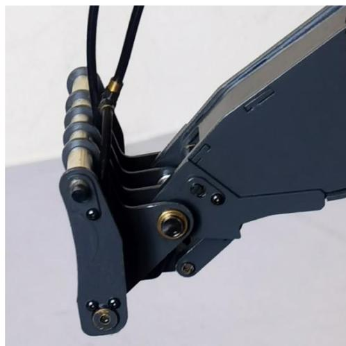
3. Schalten Sie die Ölpumpe aus CH5, ziehen Sie den mit der Klaue verbundene Schnellverschluss nach hinten ab.
