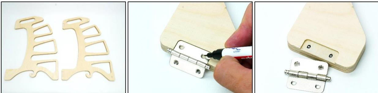
3. Jetzt können die angezeichneten Löcher mit einem 1 bis 1,5 mm Bohrer vorgebohrt werden. Dabei darauf achten nicht komplett durchzubohren. Anschließend können die Scharniere angeschraubt werden indem die Seiteneile wie in dem letzten Bild unten gelegt werden.
