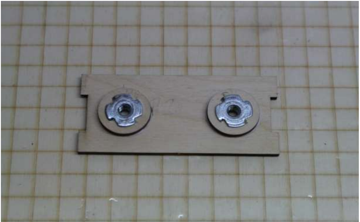
Einschlagmuttern M5 für Tragflächensicherung einziehen
