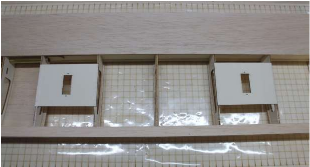
Servobrettchen 2× (C3) verleimen
