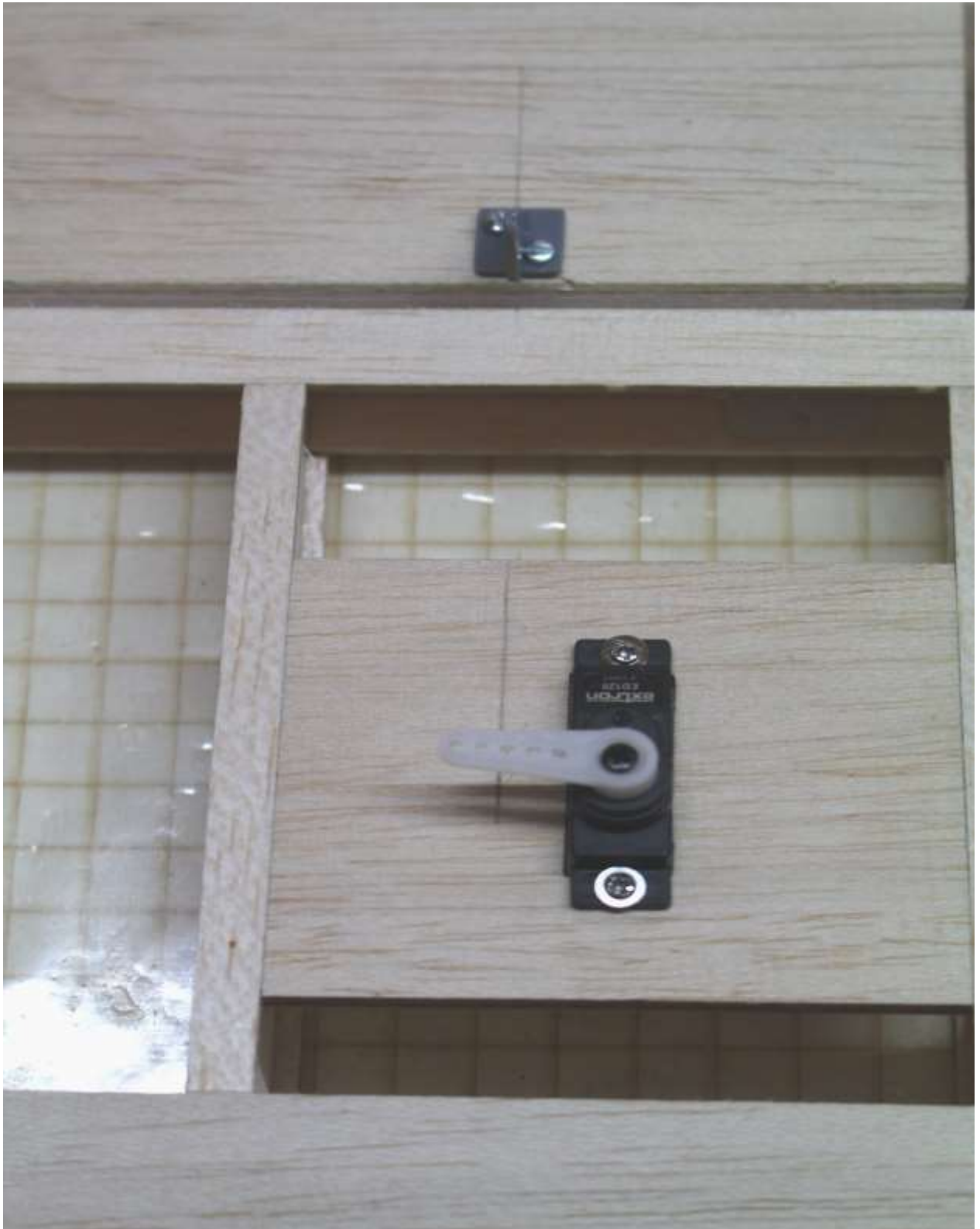
Lage der Ruderhörner ermitteln Ruderhörner an Querruder und Landeklappe verschrauben
