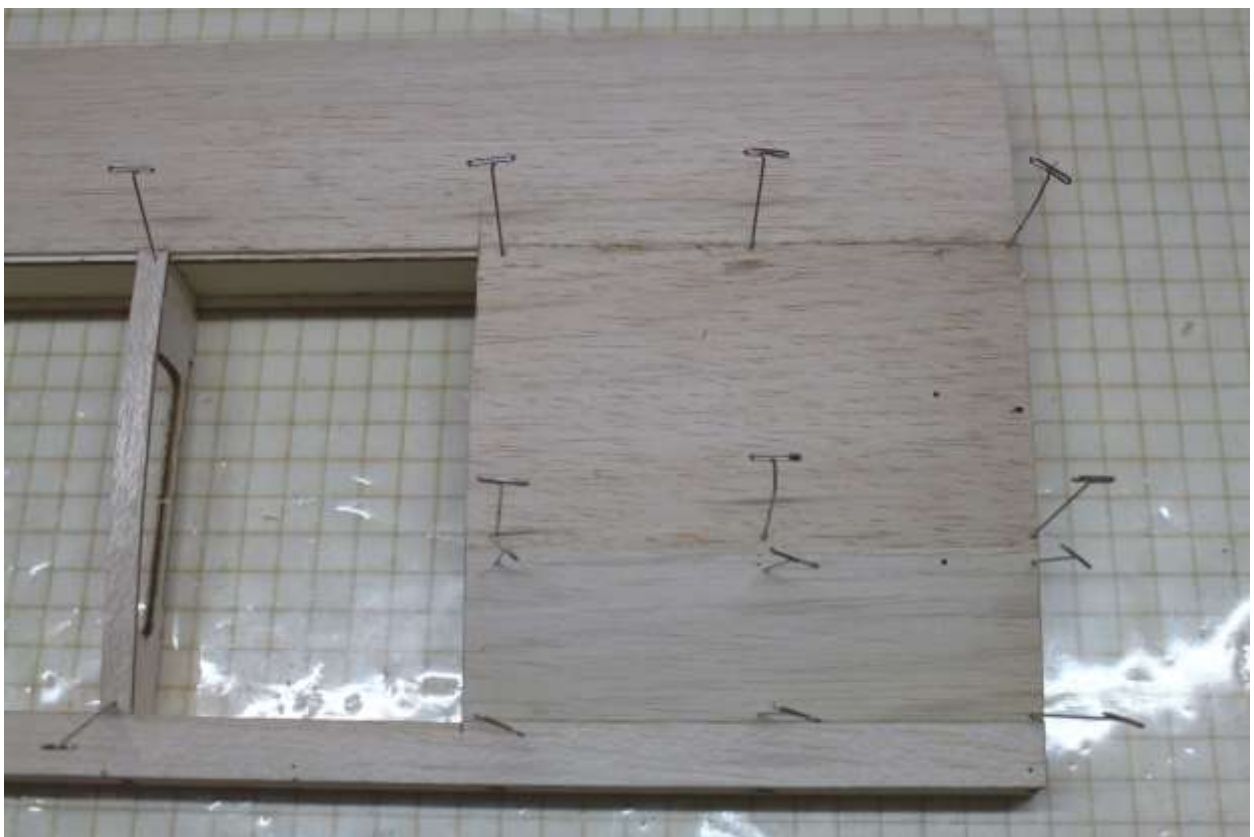
Wurzelbeplankung (1,5-mm-Balsa) zuschneiden und verleimen
