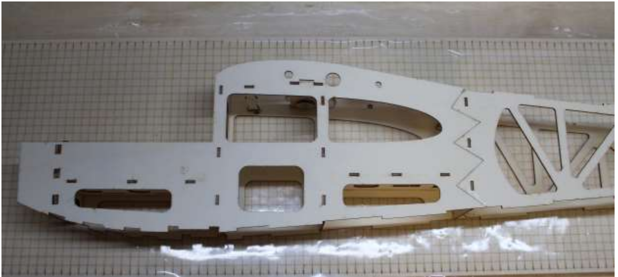
Zweites Rumpfseitenteil auf Spantengerüst auflegen und verleimen
