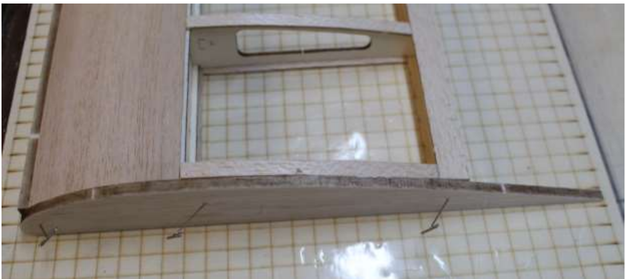
Abschlussrippe (G) an Endrippe (J1) verleimen
