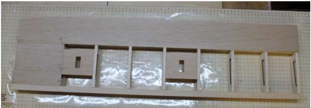
Untere Wurzelbeplankung (1,5-mm-Balsa), Servobrett-Bepankung (Q) und Rippenaufleimer (P) ablängen und verleimen
