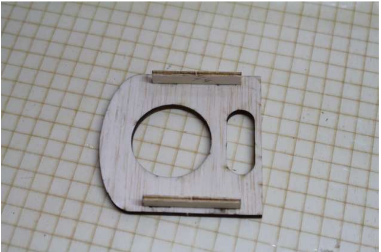
Laschen (F4) mit Frontverkleidung (G) verleimen
