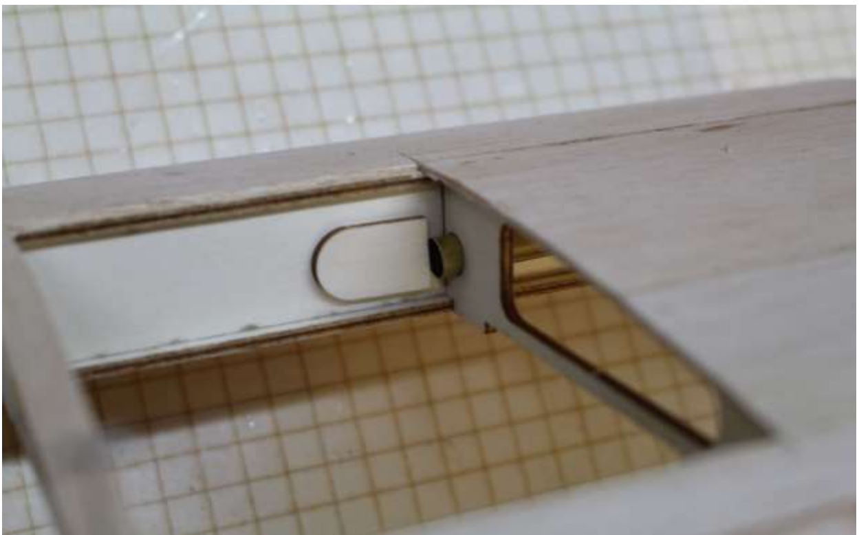
Aus einem Stück Restholz Anschlag zuschneiden und verleimen. Hinweis: Der Anschlag verhindert ein zu weites Einschieben des Tragflächenverbinders
