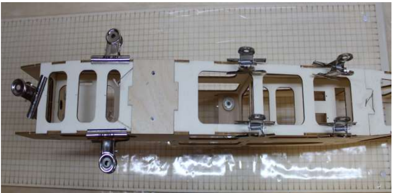
Teile für den vorderen, unteren Rumpfboden (F3 und F5) und Fahrwerksbefestigung (A5/A6) verleimen
