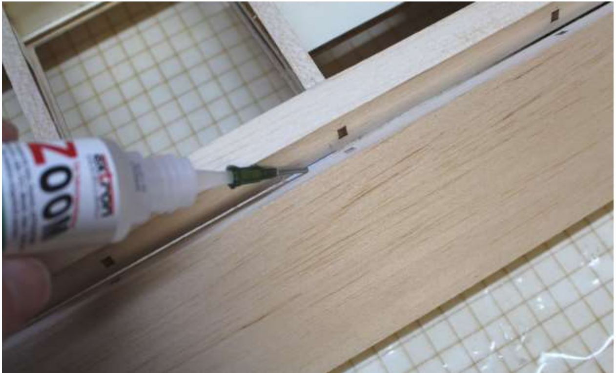
Scharniere mit Sekundenkleber verkleben (erst nach dem Bespannen)
