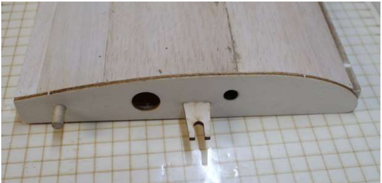
Verdrehbolzen (Buche Ø6×30 mm) und Halter für Tragflächenverschraubung (A2) in Wurzel- bzw. Deckrippe (I3) verleimen
