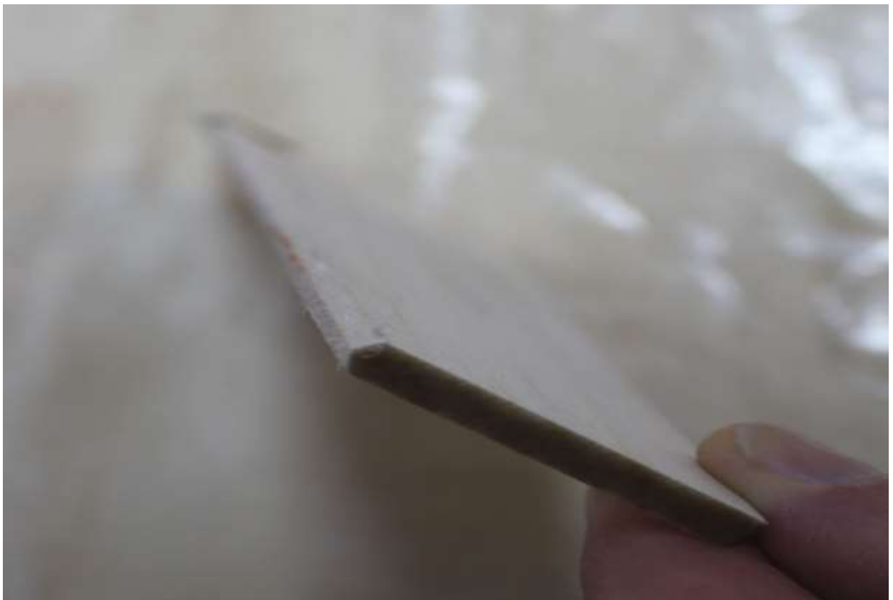
Vorderkante des Seitenruders (N7) spitz (ca. 90°) zuschleifen
