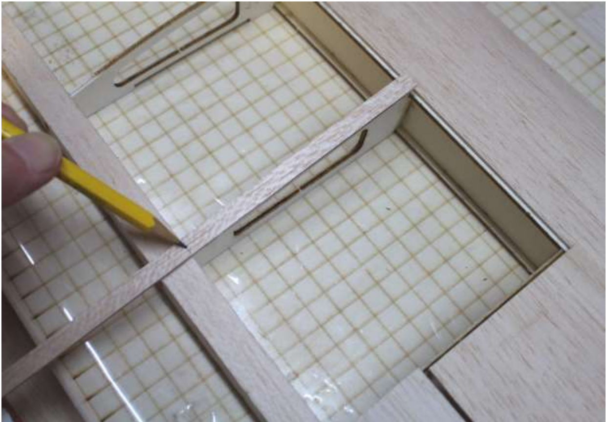
Rippenaufleimer (Brett P) ablängen und verleimen
