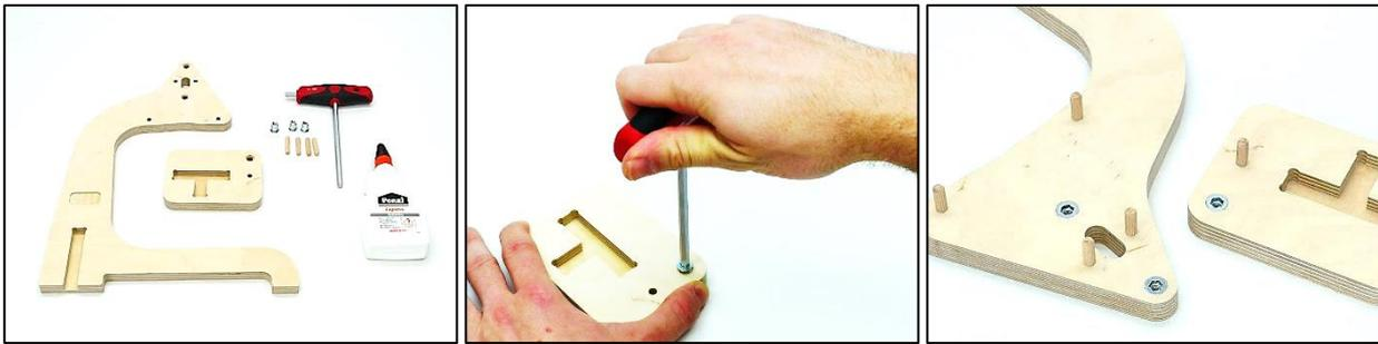
3. Jetzt kann das gezeigte Bauteil an das Grundgestell geklebt werden. Hierzu etwas Kleber auftragen und auf die vorher eingesetzten Holzdübel aufsetzen. Das Ganze dann mit Schraubzwingen sichern bis der Kleber ausgehärtet ist.
