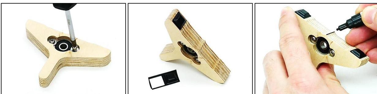
6. Als nächstes alle Flächen der Steckung dünn mit Holzleim einstreichen und alles zusammenstecken. Hierbei auf die richtige Grundplatte wie in der Abbildung mit den Pfeilen dargestellt achten (Das Einschraubgewinde in der Grundplatte ist auf der Gegenseite der Holzdübel). Alles mit einem Anschlagwinkel und Schraubzwingen fixieren und austrocknen lassen.
