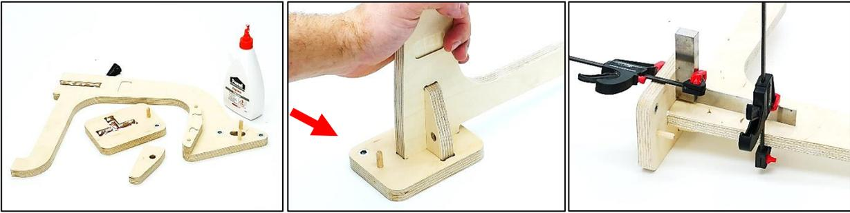
7. Anschließend können die Wippen montiert werden. Hierzu die M6x30 Schrauben auf der Seite der Lagerfixierung einstecken und auf der anderen Seite vier kleine M6 Scheiben und abschließend eine große M6 Scheibe aufstecken. Das Ganze dann an das Grundgestell wie dargestellt anschrauben.
