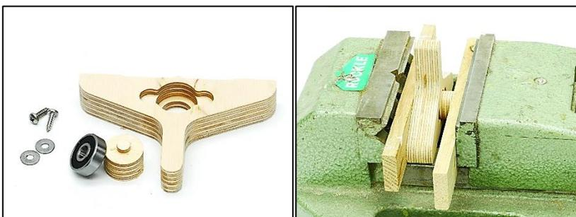
5. Anschließend wird das Lager mit den M3 Scheiben und den Blechschrauben gesichert. Hierzu einfach die Scheiben neben das Lager legen und die Schrauben ohne vorzubohren mit etwas Druck einschrauben. Anschließend die Gummiauflagen wie abgebildet aufkleben. Zum Schluss noch mit einem Permanent Marker die Erhebung für die Anzeige des Schwerpunktes nachzeichnen.
