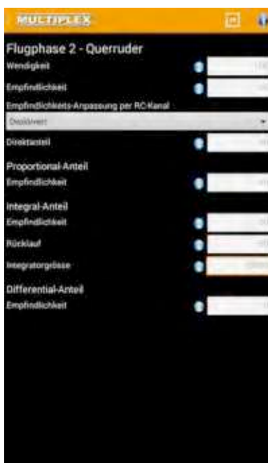
Illustration 30 : Réglage des phases gyroscopiques sur le WINGSTABI
