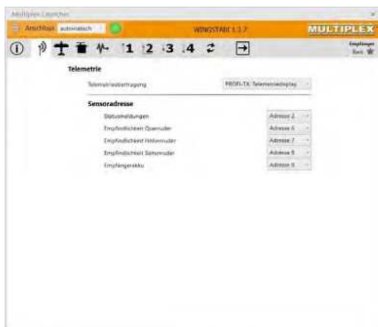
Abbildung 24: PROFI TX Telemetreeinstellungen
