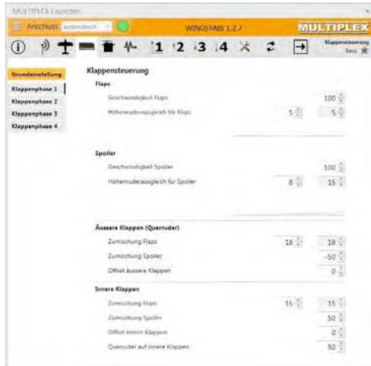
Illustration 20 : Réglages de base des volets - planeur
