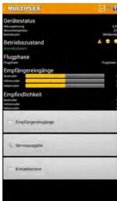
Abbildung 29: Statusmeldungen der WINGSTABI Verbindung
