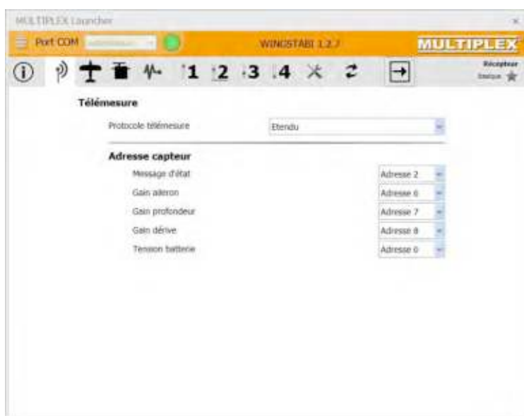
Illustration 24 : Réglages de télémétrie PROFI TX
