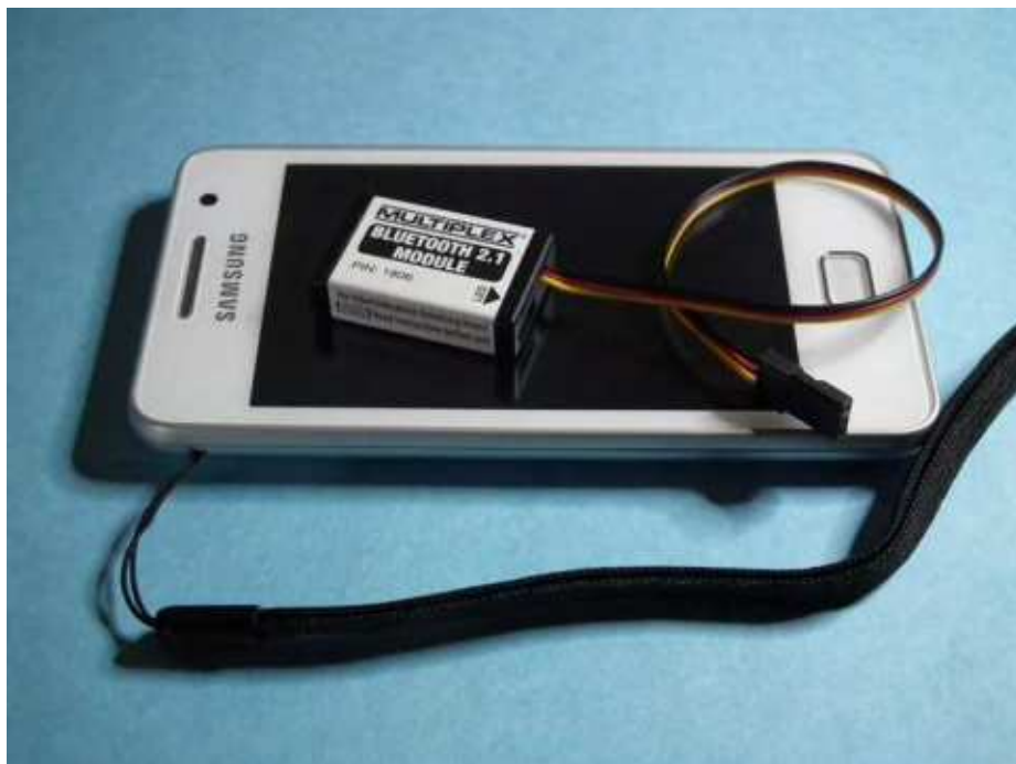
Abbildung 25: MPX Bluetooth-Adapter für WINGSTABI
