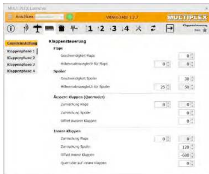
Illustration 15 : Réglages de base des aérofreins
