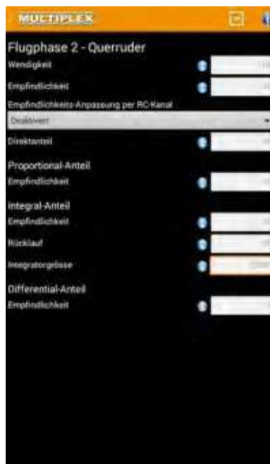
Abbildung 30: Kreiselphaseneinstellung am WINGSTABI
