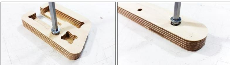
4. Geben sie jetzt etwas (ca. 3 Tropfen) mitteldicken Sekundenkleber in die 6 mm Bohrung und drücken sie den Passtift ein. Nehmen sie direkt einen Hammer und schlagen den Stift bis auf den Grund der Senkung. Darauf achten, dass das Bauteil auf einer festen Unterlage liegt um ein durchschlagen des Stiftes zu verhindern. Herausdringenden Kleber sofort entfernen.
