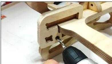
3. Schrauben sie die Gewindeeinsätze mit einen 6 mm Innensechskant jeweils aus der Richtung der Flachsung ein. Beim Ansetzen etwas Druck ausüben und fest eindrehen bis der Gewindeeinsatz bündig abschließt.
