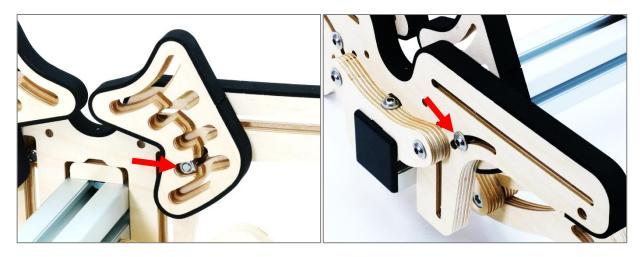
15. Im nächsten Schritt werden die Haltestäbe vorbereitet. Dazu wird eine Vierkantmutter in die kleinere Nut eingelegt und von der anderen Seite mit einer Schraube verschraubt. Dies dient später als Verdrehsicherung.
