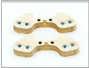
3. Jetzt werden alle Holzdübel in die Teile eingesetzt. Hierzu wenig Kleber in die 6 mm Löcher geben und die Holzdübel auf einer harten und ebenen Unterlage vorsichtig einschlagen. Abschließend die Teile wie dargestellt zusammenfügen. Hierbei sollte eine Schonhammer oder ein Reststück Holz verwendet werden, um die Oberfläche der Teile nicht zu beschädigen. Beim zusammen bauen unbedingt auf die richtige Orientierung der Teile achten.
