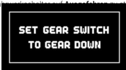
Der Assistent öffnet nun alle Türen und fährt das Fahrwerk in die **Ausfahren** Position. Prüfen Sie den Sequenzer Ablauf nun mit Ihrem Fahrwerkschalter. Sollte zum Beispiel die Pause zwischen Fahrwerk und Türen zu kurz sein, können Sie erneut den Assistenten auswählen und diese Einstellung verändern. Die Positionen der Türen müssen nicht erneut eingestellt werden.
