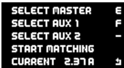
Schließen Sie nun das zweite und ggf. das dritte Servo an den gewünschten Ausgängen an und verbinden Sie die mechanischen Anlenkungen. Wählen Sie nun bei AUX1 und ggf. bei AUX2 die weiteren Teilnehmer aus. Diese Ausgänge werden bei der Auswahl dem gleichen Eingangskanal zugeordnet wie das **Hauptservo** und initialisiert. Sie müssen die Zuordnung der *Teilnehmer* also nicht zuvor im **Output Mapping** einstellen und sie auch nicht initialisieren.
