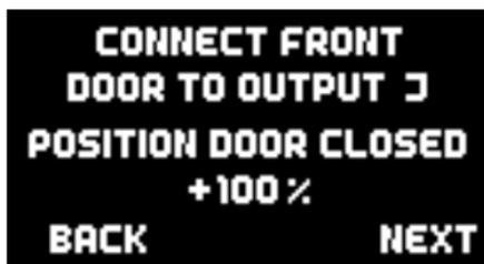
Abhängig davon, welche Anzahl an Türen Sie eingegeben haben, erfolgt nun die Einstellung der Positionen der Fahrwerksteuerung und aller Türen. Schließen Sie die Fahrwerkssteuerung und die Türen an den angegebenen Ausgang der **PowerBox Mercury SR2** an. Der Assistenten sucht beginnend bei **A** nach Ausgängen, die keine Sonderfunktionen haben – also **Direkt-xy** Ausgänge, die nicht mit einer Gyro- oder anderen Sequenzer Funktion belegt sind.
