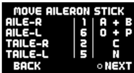
Bewegen Sie nun den Querruder-Stick am Sender. Die PowerBox überprüft die Eingabe: In diesem Beispiel müssen sich 4 Kanäle bewegen. Zwei für das rechte und linke Querruder und zwei für die beiden Tailerons.
