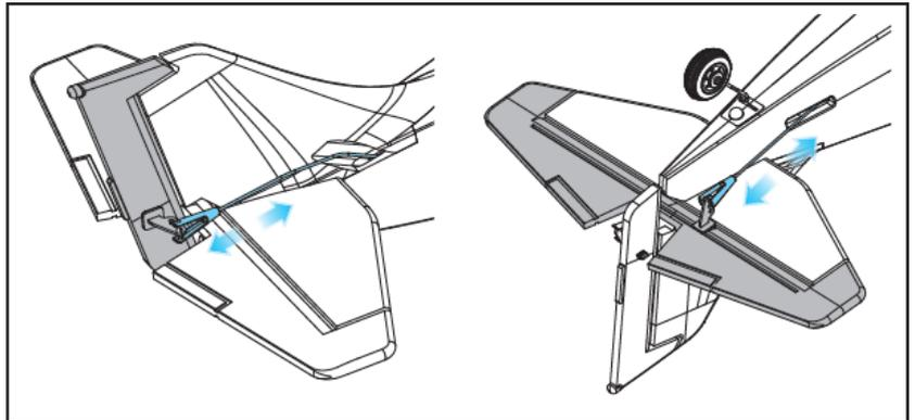
Über die Ruderanlenkung, können die Ruder korrigiert werden. Drehen Sie dazu am Gabelkopf um die Länge zu ändern.
