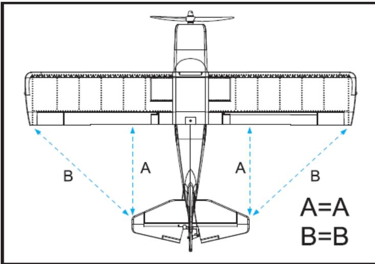
Stellen Sie sicher, dass die Tragfläche korrekt installiert ist.
