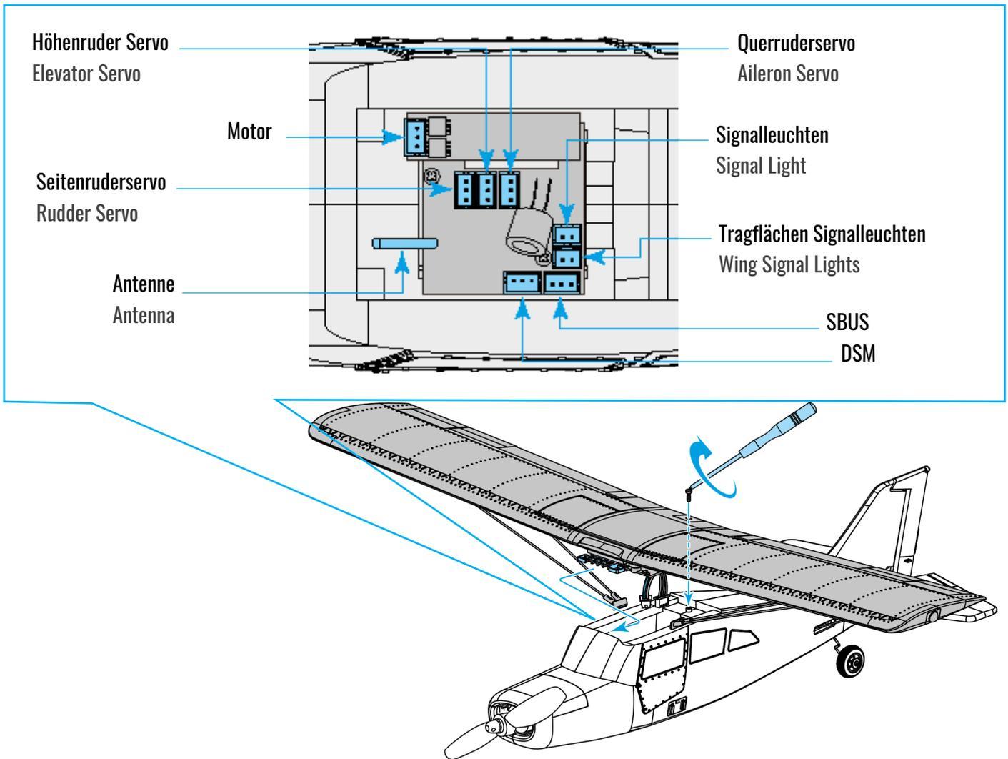
Wie in der Zeichnung gezeigt, Schließen Sie zuerst den Querruderservo an und installieren Sie dann die Tragflächen auf dem Rumpf.
