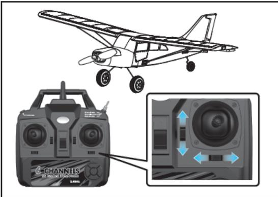
Beide Hebel in der Mittelstellung. Nach der Justierung sollten sich sowohl Seiten als auch das Höhenruder in der Mittelstellung befinden.
