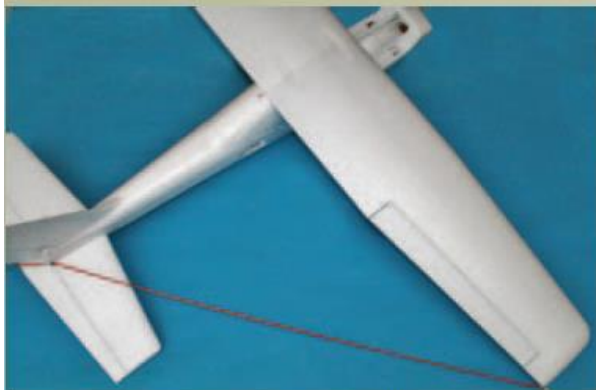
Ebenfalls mit einer nicht dehnbaren Schnur wird die korrekte Ausrichtung der Tragfläche überprüft.
