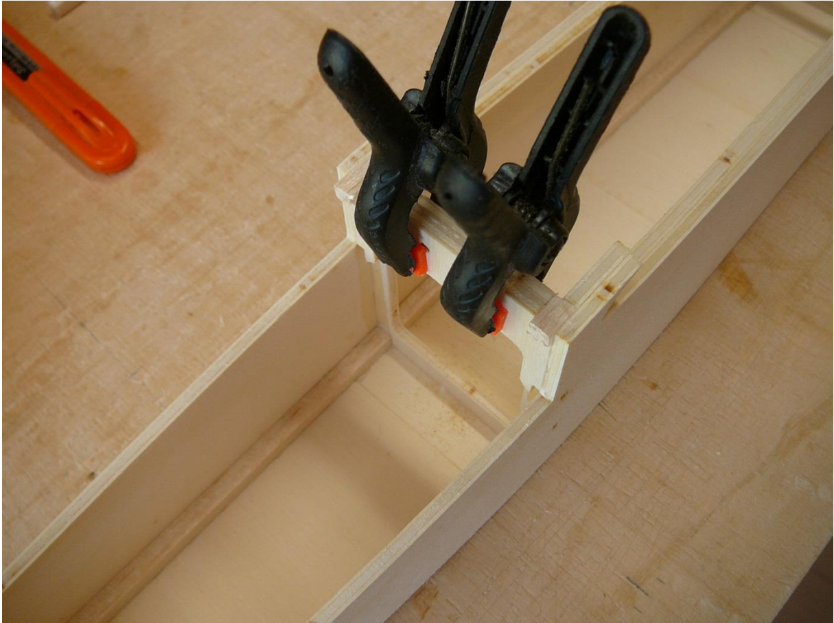
Hilfspant Steckung einkleben.
