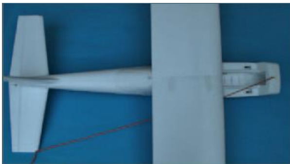
Ausrichten des Höhenleitwerks. Die Abstände müssen auf beiden Seiten gleich sein. Zur Verdeutlichung wurde eine besonders dicke Schnur verwendet.
