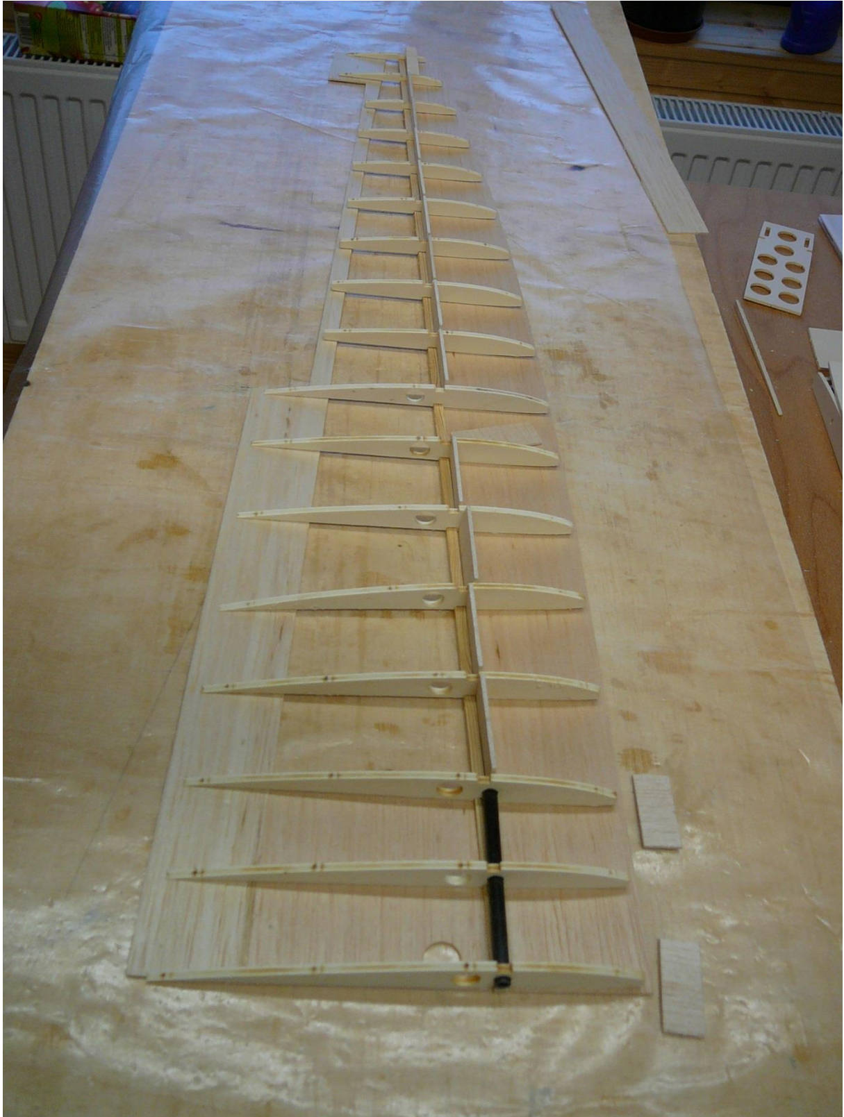
Die Rippen provisorisch mit der Verkastung als Abstandhalter auflegen.
