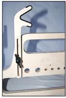
10. Zum Abschluss muss das Teil-Q Logo in die Aussparung gesetzt werden. Schleifen sie dazu die Rückseite des Logos leicht an und verwenden sie beim einsetzten nur ganz wenig Kleber, da das Logo sehr passgenau sitz.
