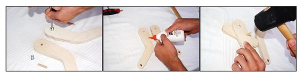
6. Gewindeeinsatz in das Zwischenstück von der Seite der Aussparung des Teil-Q Logos eindrehen. Beim Ansetzen etwas Druck ausüben und fest eindrehen bis der Gewindeeinsatz bündig abschließt.
