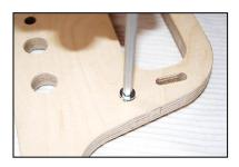
7. Bei den restlichen Teilen Gewindeeinsätze mit einen 6 mm Innensechskant jeweils aus der Richtung der Flachsenkung eindrehen. Beim Ansetzen etwas Druck ausüben und fest eindrehen bis der Gewindeeinsatz bündig abschließt. Es befinden sich zwei Flächenhaltern mehr als notwendig in dem Bausatz. Dies ist weil diese Teile beim eindrehen der Gewindeeinsätze teilweise je nach Holzbeschaffenheit an dieser Stelle in Einzelfällen brechen können.
