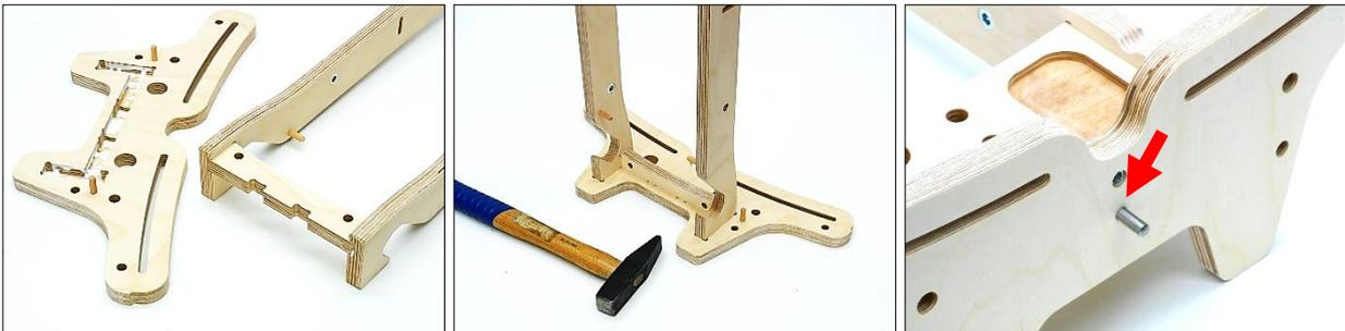
6. Jetzt mit etwas Klebeband auf der Gegenseite Innen die Kanten zum Seitenteil abkleben. Dies verhindert ein Verlaufen des Klebers beim nächsten Schritt und wird nach dem Aushärten des Klebstoffes wieder entfernt. Jetzt ausreichend Klebstoff in die zwei Ausschnitte geben und die Haken einsetzen. Wenn die Haken eingesetzt sind, diese nach unten drücken damit diese stabil in dem Ausschnitt sitzen
