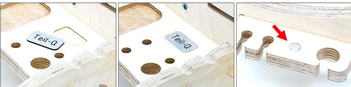
11. Jetzt kann die Montage beginnen. Die Klemmleisten werden von Innen eingesetzt und mit einer Flügelmutter und einer großen M6 Scheibe verschraubt.
