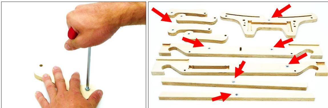
3. Jetzt werden alle Holzdübel in die Seitenteile gesetzt. Hierzu ganz wenig Kleber in das Loch geben und die Holzdübel auf einer harten Unterlage einschlagen
