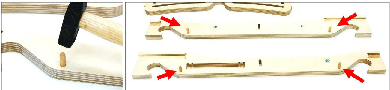
4. Als nächstes alle Flächen der Steckung wie abgebildet dünn mit Holzleim einstreichen und alles zusammenstecken. Zuerst die beiden Seitenteile mit der Ablage verbinden und dann zusammen in das Seitenteil stecken.
