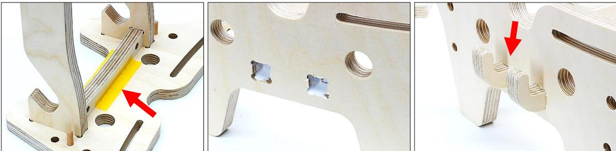
7. Jetzt wird noch die Werkzeugablage des Mittelteils montiert. Hierzu etwas Kleber in den Ecken verteilen und die Ablage von Innen einschieben. Die Aussparung für den Magneten muss nach oben zeigen.
