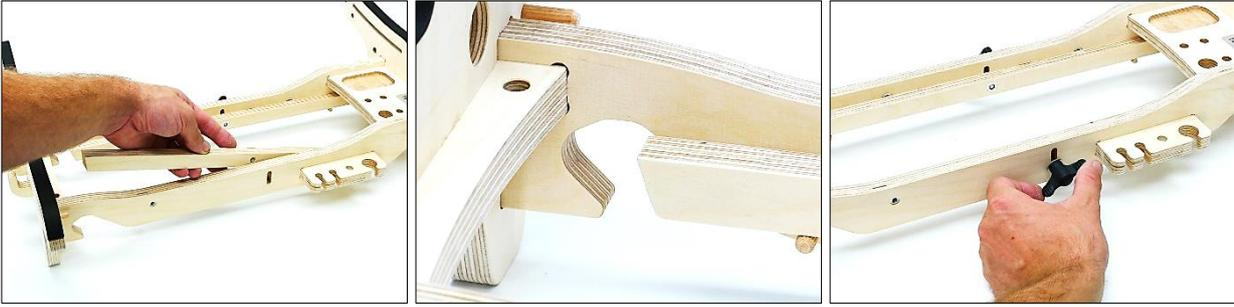
12. Anschließend werden die Ohren, die Höhenverstellung und der Flächenhalter mit jeweils einer Flügelschraube und einer großen M6 Scheibe montiert und die GummifüÙe aufgeklebt.
