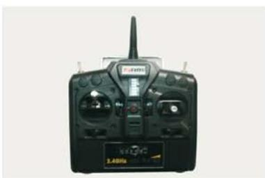
23. Den Sender einschalten, BEVOR Sie den Akku an das Flugzeug anschließen.
