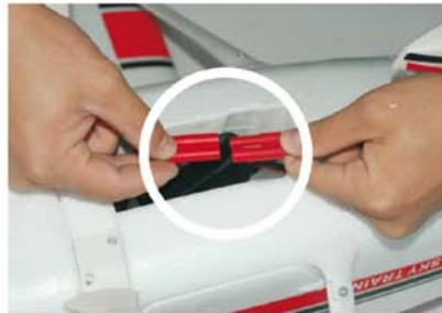
4. Den Akku an das Flugzeug anschließen, dann Höhen- und Seitenrudder justieren.
