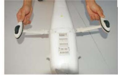
2. Das Hauptfahrwerk montieren.
