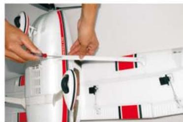
20. Die Stützstange montieren mit der Schraube PM3x8(4Stk.)
