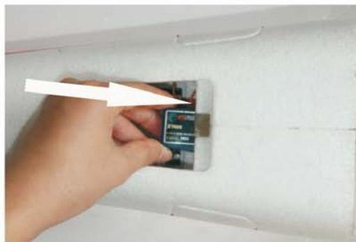
Die Verbinder müssen anhand der Signalkabel korrekt angeschlossen werden. Drücken Sie den Empfänger in den Rumpf.
