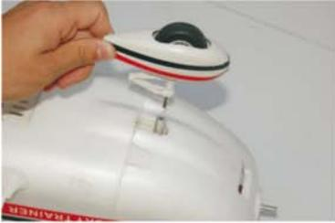
1. Das vordere Fahrwerk montieren.
