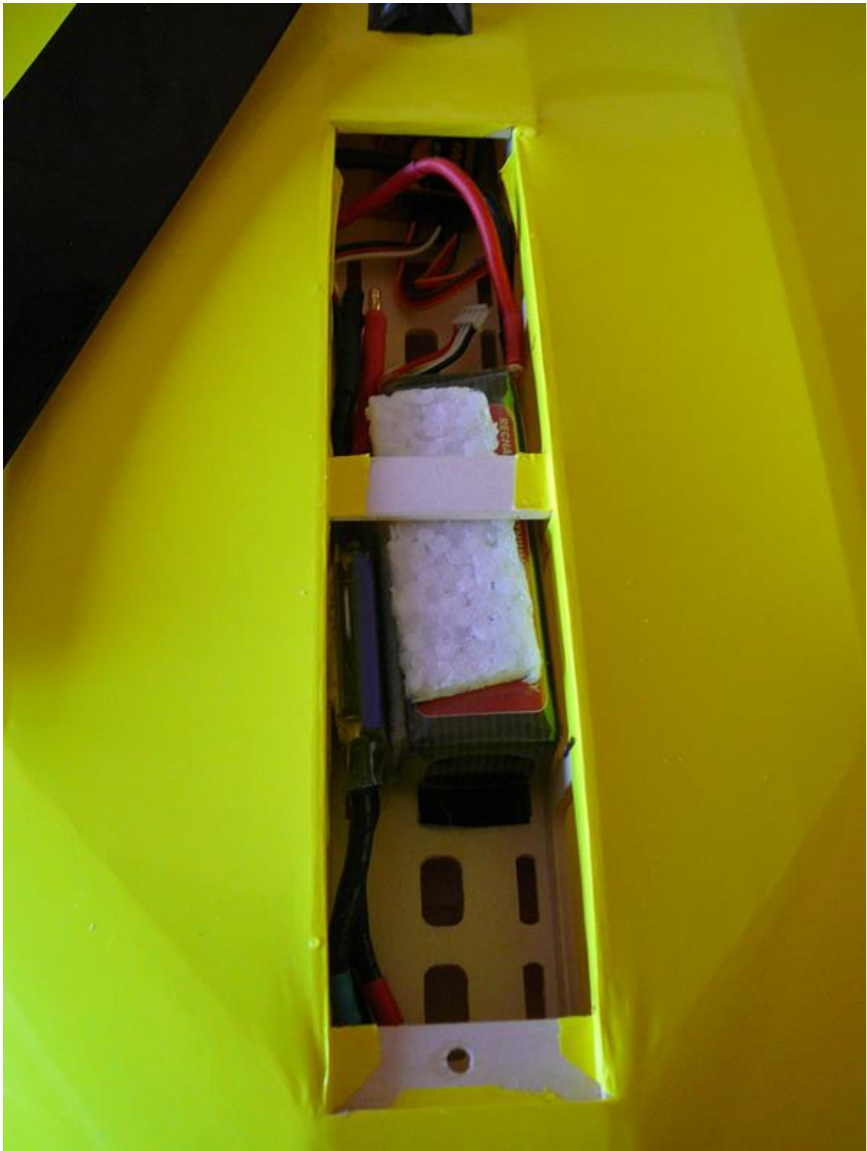
Akku und Regler mit Klettband befestigen.
