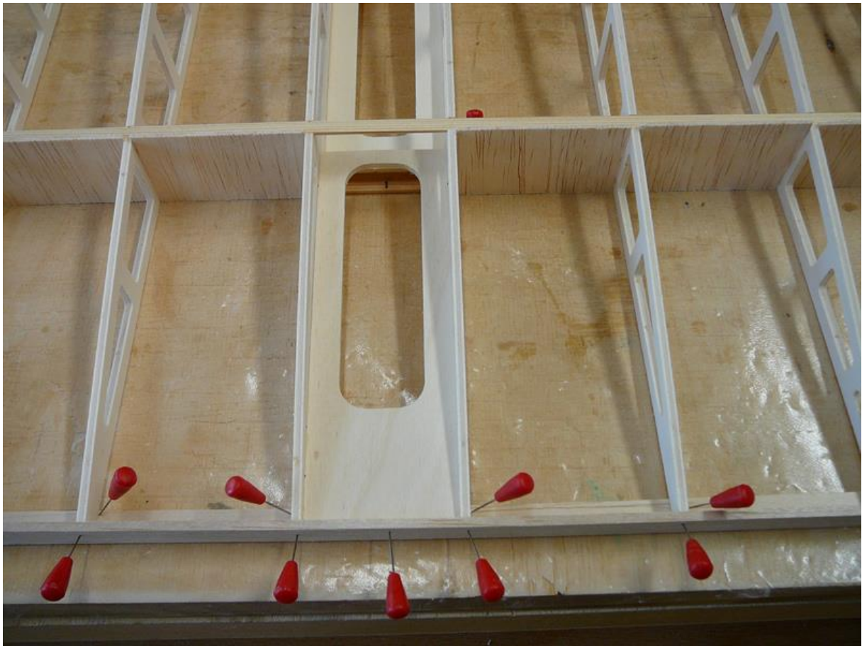
Balsa Rippenabschluss 3x13x850mm an Rippenenden ankleben.
