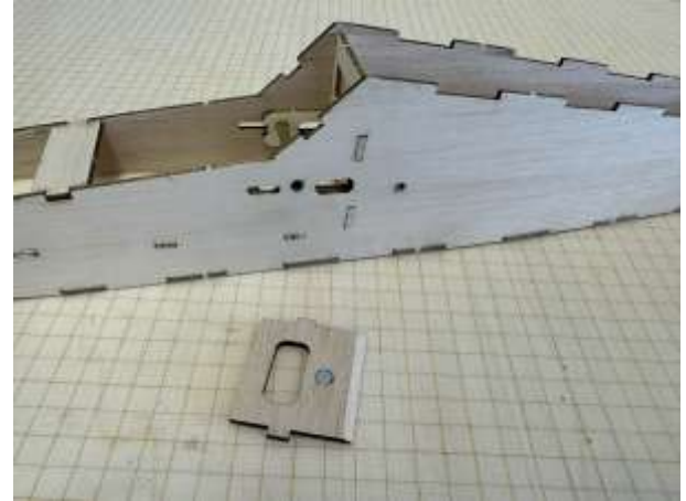
Bauteil C5 schräg anschleifen
