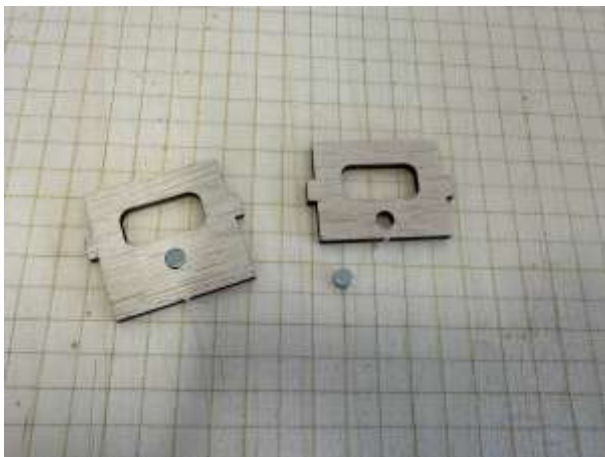
Magnete in die Teile C3 und C5 einkleben (Polarität beachten)
