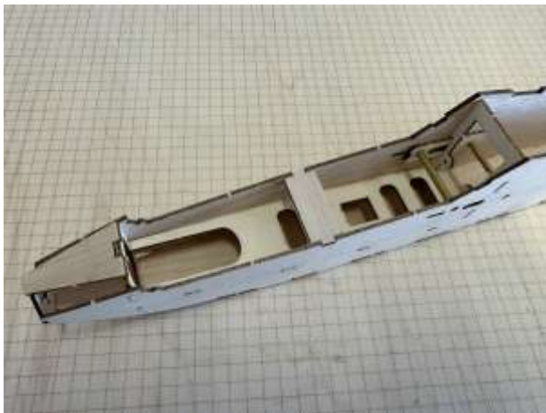
Messingrohre 5x50mm und 4x50mm sowie Bauteil B4 einkleben
