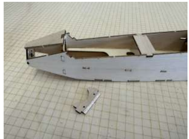
Bauteil C5 in den Rumpf einkleben. Das Bauteil C3 probeweise aufsetzen und die Magnetwirkung prüfen
