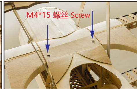
上机翼锁定位置 Upper wing locked position 中机翼锁定位置 Middle wing locked position 下机翼锁定位置 Lower wing locked position
