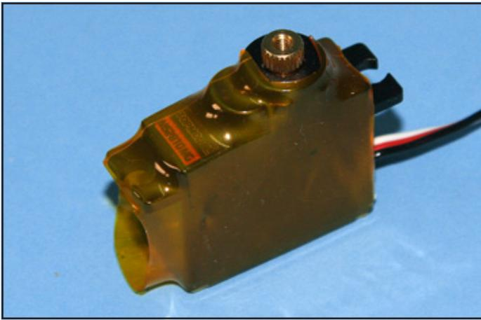
2) Placez chaque servo dans un morceau de gaine thermorétractable fournie et rétractez les gaines avec un pistolet à air chaud ou un briquet.
