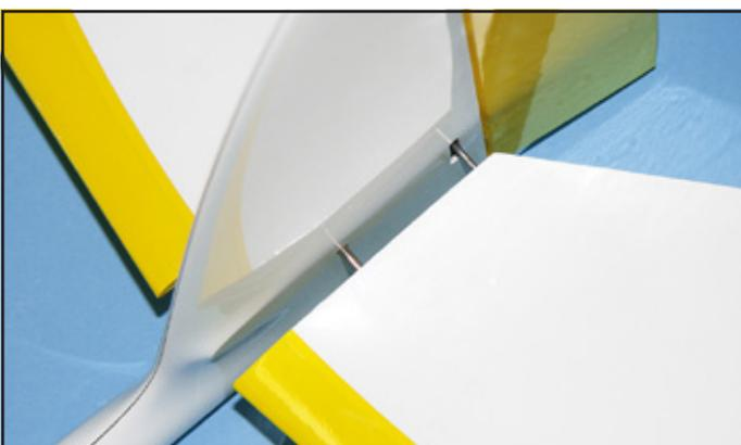
7) Insérez les clés de stab dans la dérive. La plus petite doit passer dans le trou du renvoi pendulaire de profondeur.
