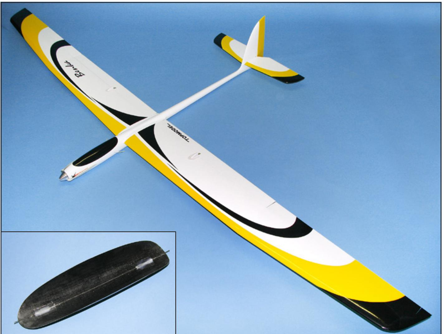
11) La verrière se monte grâce à la corde à piano collée. Glissez l'avant, avancez l'ensemble, glissez la c.a.p. à l'arrière.
