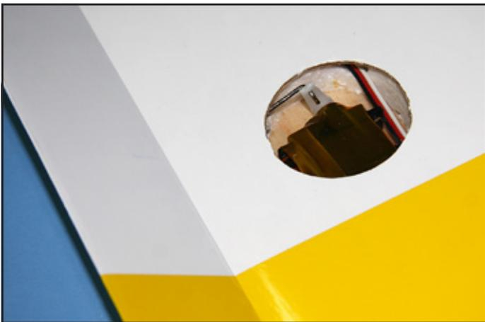
13) Avec votre radio, testez le fonctionnement du volet qui doit pouvoir débattre très légèrement vers le haut et très fortement vers le bas. (Voir les débâtements en fin de manuel). Au besoin, ajustez la sortie de commande pour éviter les frottements.
