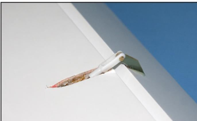
14) Découpez et collez le cache de servo de volet ainsi que le cache de sortie de commande côté extrados.
