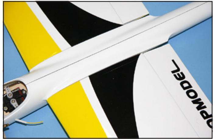
9) Glissez la clé d'aile dans le trou du fuselage. Glissez chaque aile sur la clé, et connectez les servos aux rallonges. Plaquez les ailes contre le fuselage en insérant les connecteurs dans le fuselage.
