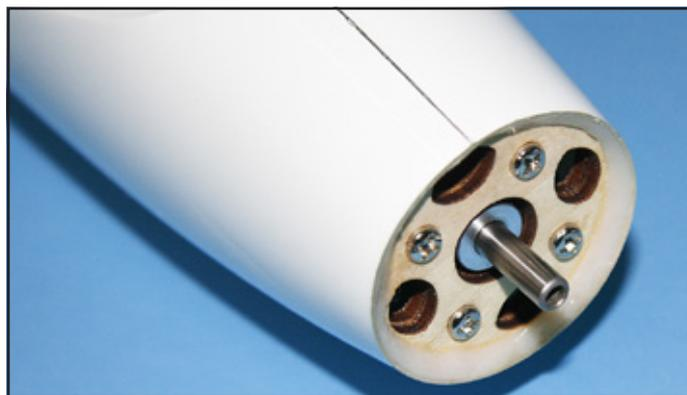
3) Fixez le moteur sur le couple avant avec 4 vis M3 fournies avec le moteur.
