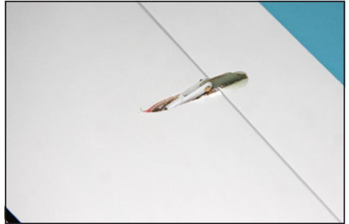
11) Montez la seconde commande sur le guignol de volet en la passant dans l'ouverture à l'extrados de l'aile.
