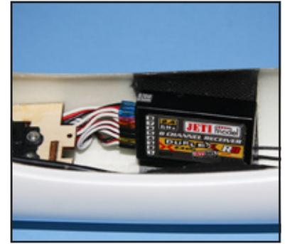
3) Connectez les servos, les rallonges et le contrôleur au récepteur.
