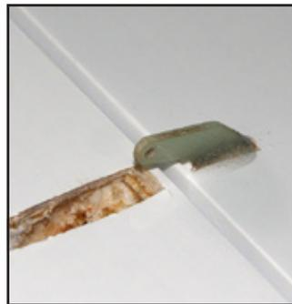
7) Avec de l'époxy, collez le guignol d'aileron dans la fente à l'intrados de l'aileron, et le guignol de volet tourné vers l'avant dans la fente à l'extrados du volet.
