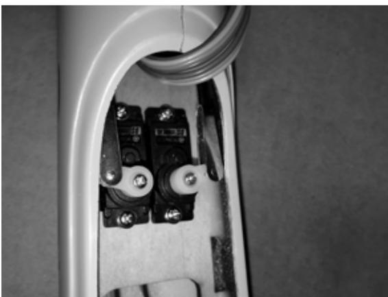
Das Anlenkgestänge vom V-Leitwerk mit dem Servohebel verbinden. Den Gabelkopf durch drehen justieren, sodass das V-Leitwerk mittig steht. Gabelkopf und Mutter mit Schraubensicherungslack gegen verdrehen sichern.
