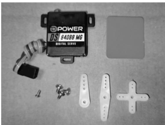
Für den Einbau der Querruderservo wird das abgebildete Servo und Servozubehör benötigt.
