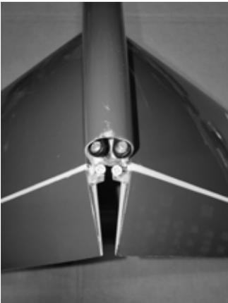
Die beiden Anlenkgestänge mit den fertig eingeklebten Anlenkungen der V-Leitwerkshälften verbinden.
