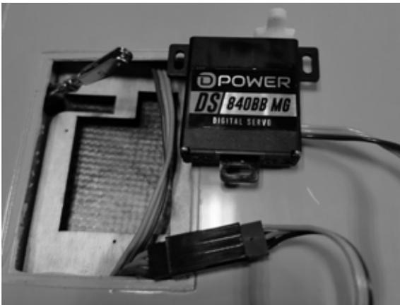
Das Servoanschlusskabel mit dem bereits in der Tragfläche eingezogenen Verlängerungskabel verbinden und das Kabel im Schacht verstauen.
