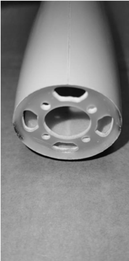
Den Motor mit passenden Schrauben am Motorspant befestigen (Schraubenlänge berücksichtigen!). Die Schrauben gegen lösen mit Schraubensicherungslack sichern.
