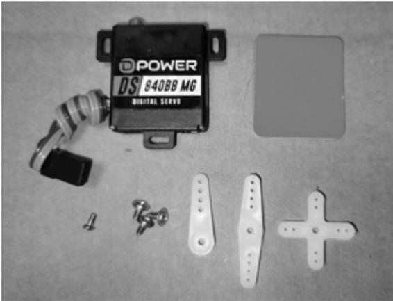
Für den Einbau der Wölbklappenservos wird das abgebildete Servo und Servozubehör benötigt.
