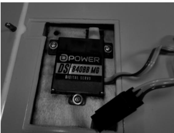
Das Servo mit den Schrauben am Servorahmen im Servoschacht befestigen.
