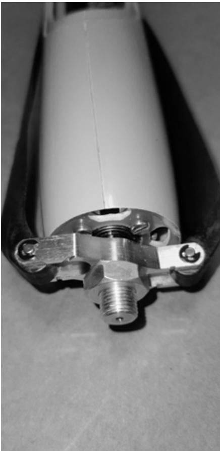
Die passenden Luftschraubenblätter am Spinner befestigen und den Spinner auf die Motorwelle stecken. Den Spinner nur soweit auf die Motorwelle stecken das dieser nicht am Rumpf schleift und trotzdem möglichst nah am Rumpf sitzt. Dann den Spinner an der Motorwelle befestigen. Dafür die Spinnerkappe entfernen und die Mutter darunter anziehen.
