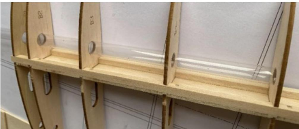
**59-60:** Zwei Stück 3mm Sperrholz werden zur Verstärkung an der Stelle verwendet, an der die Flügelstrebe befestigt ist.
