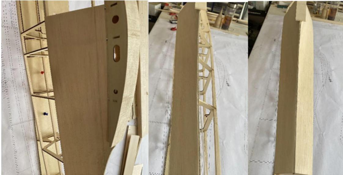
**12:** Schleifen Sie die Seitenabdeckung und stellen Sie sicher, dass sie rechtwinklig zu den Schotten ist.
