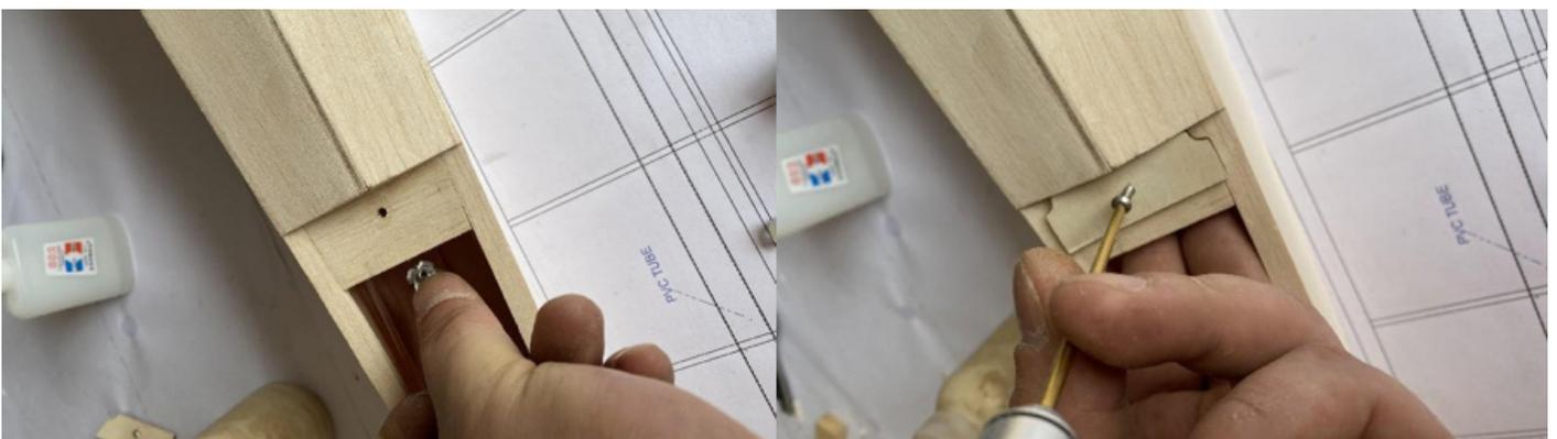
**35-36:** Markieren Sie die entsprechende Position des PVC-Rohrs und schneiden Sie das Loch für die Zugstange aus.
