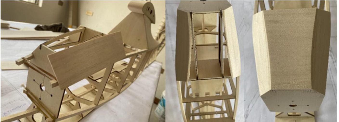
**17:** Verstärken Sie das Gehäuse mit Kiefernholz (es wird an beiden Enden Metallverbinder haben, um die Flügelstreben zu befestigen).
