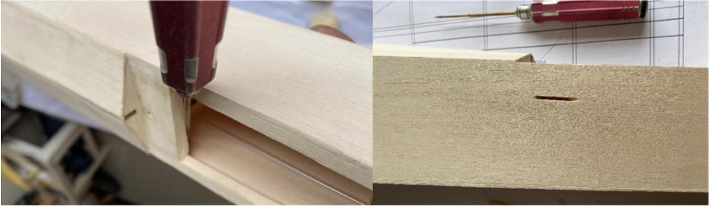
**37-38:** Den Rumpf mit fertigem Höhenleitwerk und Höhenruder anzeichnen und Störstellen ausschneiden.
