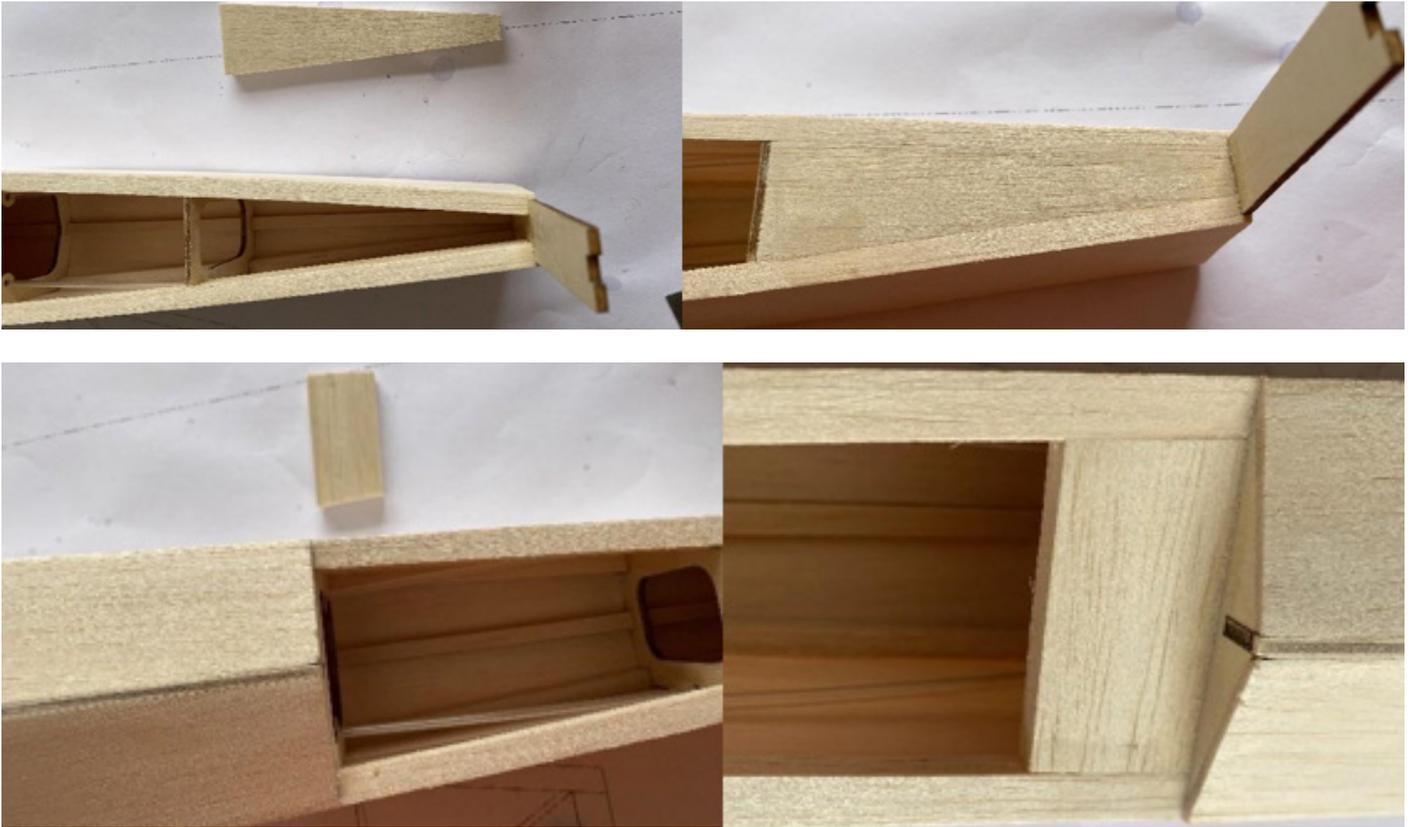
**30-32:** Bauen Sie das Seitenleitwerk und die Abdeckung gemäß der Zeichnung (A23-24).
