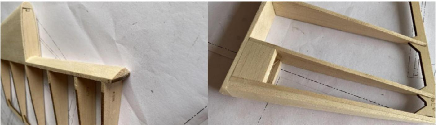
**91:** Klebe 8mm Balsa auf den oberen und unteren Teil des Ruders und schleifen Sie sie in Form.
