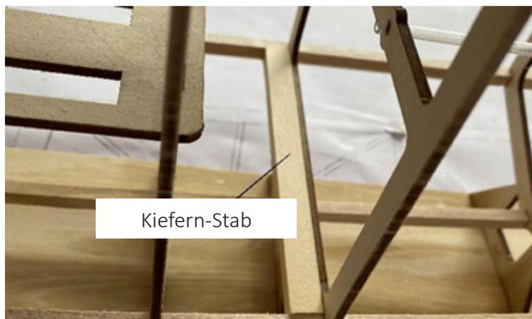
**18-19:** Kleben Sie die Rumpfabdeckung (2mm Balsa). Die Länge der Abdeckung muss angepasst werden.
