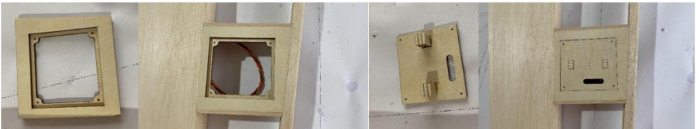
**81-82:** Schneiden Sie ein Loch in den Metallstecker, führen Sie ihn durch wie abgebildet und befestigen Sie ihn mit den selbstschneidenden Schrauben.
