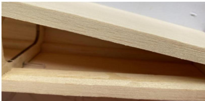
**26-29:** Höhenleitwerk wurde mit 8mm Balsaplatten gefüllt und verklebt.
