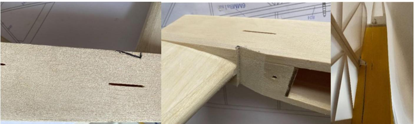
**37-38:** Den Rumpf mit fertigem Höhenleitwerk und Höhenruder anzeichnen und Störstellen ausschneiden.
