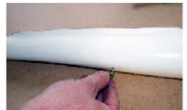
106. Vlečný háček #1-4 namontujeme do prostředního otvoru - polohu háčku doladíme při zalétávání ... mount drak hook #1-4 to the central hole - hook position will be adjust during first test flying.
