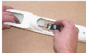
137. ...servo vsuneme do držáku... ... insert servo to the holder ...
