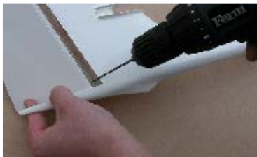
143. V klapce směrovky vyvrtáme otvor Ø3,2, pro páku #4-8... Drill hole Ø 3.2 on the rudder for horn #4-8 ...
