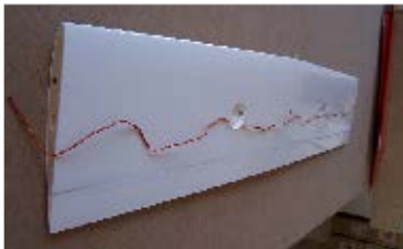
24. Připravíme si kroucený kabel k prodloužení servokabelů Prepare twisted cable for servo cables extension.
