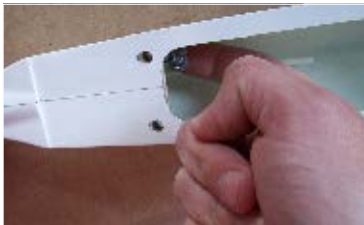
99. ...vtlačíme matice #2-3... ... stuff nuts #2-3 ...
