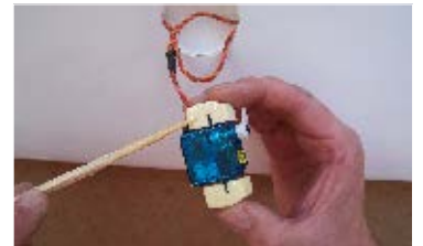
60. Stejným způsobem nainstalujeme i druhé servo křídledek Install second aileron servo, use same method.
