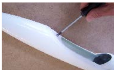
83. ...zašroubování / vyšroubováním vrtu #6-1 ... doladíme zajištění kabiny na trupu ... adjust loock of the cockpit by screw on/screw off wood screw #6-1.
