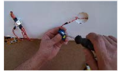
48. Páku serva nasadíme a přišroubujeme Correct position of the servo arm in centre - apply to flaps servo.
