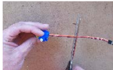
113. ...rozpůlíme kabel serva... ... halve servo cable ...
