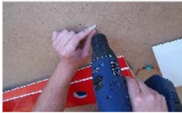
45. V pákách serv převrtáme otvory na \varnothing 1,7 - 1,8mm Drill holes \varnothing 1,7 - 1,8 mm on the servo arm.
