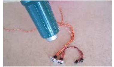
30. Bužírku "smrštíme" pomocí vhodného zdroje tepla Shring tubes, use appropriate heat source.
