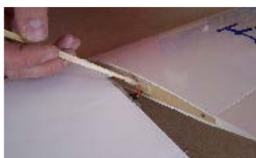
66. ...do dutiny nanese zahuštěný epoxi (dáme pozor na přetečení lepidla a slepení celého křídla)... ... put thick epoxy to the hollow (be sure to glue overflow and attach both parts of the wing) ...
