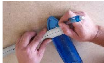
77. Na vnitřní straně kabiny #6 si naměříme střed... Measure central point on inside part of the cockpit #6 ...
