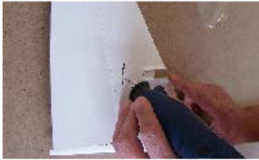
87. V kýlovce vyfrézujeme otvor pro servo výškovky... Shape hole for elevator servo in the fin ...
