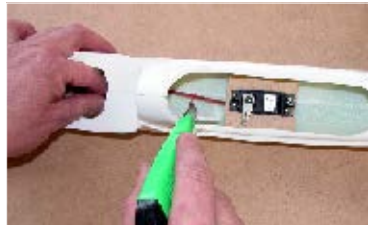
140. Podle polohy serva a sestavené koncovky táhla #4-6, zkrátíme vedení táhla v trupu Reduce length of the pushrod linkage according to servo position and clevis set.
