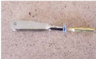
139. Sestavíme koncovku táhla #4-6 Assembly clevis set #4-6 of the pushrod.
