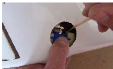
132. ...servo nastavíme, tak aby náhon výškovky byl v neutrálu, a servo zalepíme ... adjust servo, elevator drive must be in central position, glue servo to the fin.
