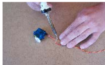
41. ...připájíme prodlužovací kabel (nezapomeneme na bužírku)... ... solder extension cable (do not forgot put tubes) ...
