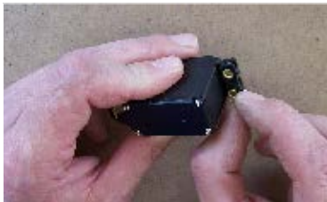
135. Zkompletujeme servo směrovky... Assembly rudder servo ...
