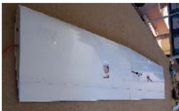
35. Křídlo s protaženými kabely Wing with inserted cables.
