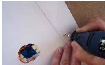
69. ...vyfrézujeme drážku... ... shape slot for arm ...
