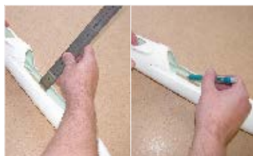
108. ...označíme si jeho polohu... ... mark holder position ...
