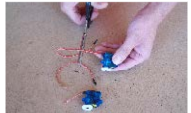
27. Rozpůlíme servokabely... Halve servo cables ...
