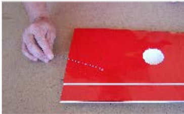
31. Připravíme si kus drátu Ø0.8 - 1mm, a na konci jej ohneme Prepare piece of the wire Ø 0.8 - 1 mm, bend one end of the wire.
