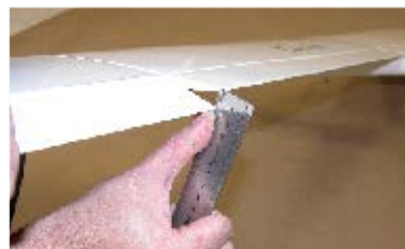
152. Křídélka dolů = 10 - 15mm... Ailerons down = 10 - 15 mm ...
