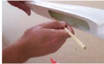
92. Do trupu, v místě, kde budou matice křídla #2-3 nanese zahuštěný 30 min. epoxi... Put thickened 30-min EPOXI to place for wing nut #2-3.
