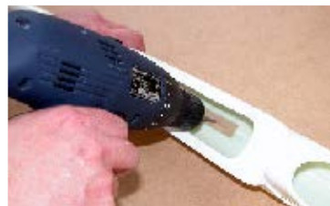
105. Vyvrtáme otvory Ø3,2mm pro vlečný háček... Drill holes \varnothing 3.2 mm for drak hook ...
