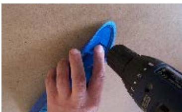
79. ...vyvrtáme otvor Ø3mm ... ... drill hole Ø 3 mm ...
