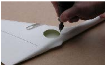
87. V kýlovce vyfrézujeme otvor pro servo výškovky... Shape hole for elevator servo in the fin ...
