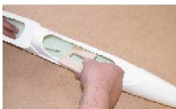
107. Do trupu vsuneme držák serva směrovky #1-2 (popř. jej obrousíme)... Insert rudder servo holder #1-2 to the fuselage (cut holder when required) ...
