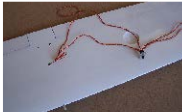
32. Drát vsuneme ohnutou částí do křídla, zachytíme jím kabel... Insert bend side of the wire to wing and grip cable ...
