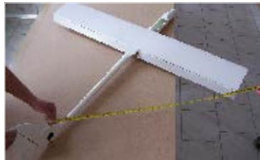
96. ...vzdálenosti musí být stejné! ... distances must be same!
