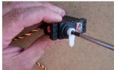
136. ...páku přišroubujeme ve středové poloze ... screw servo arm in central position ...
