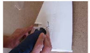
90. Zhotovíme drážku pro ovládání výškovky Shape slot for elevator controller.
