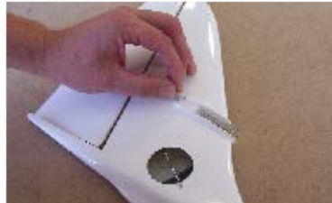
124. ...vsuneme čep páky #3-81, odzkoušíme pohyblivost páky, popř. ji upravíme... ... insert arm stopper #3-81, test mobility of the arm, adjust it when required ...
