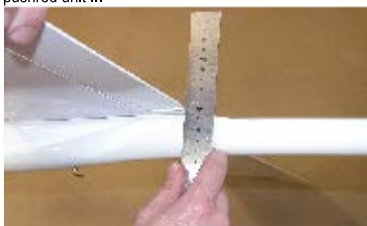
150. Výchylka klapky nahoru = 3mm... Flaps deviation up = 3 mm ...
