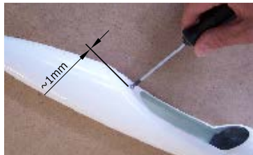
76. ... zašroubujeme vrtu #6-1 ... screw on wood srew #6-1.
