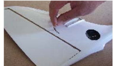
126. Do druhého otvoru v páce #3-8 vsuneme čep náhonu #3-82... Insert drive stopper #3-82 to the second hole of the arm #3-8 ...
