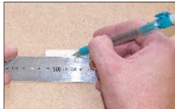
101. Na desce #1-5 si nakreslíme polohu otvorů pro vlečný háček... Draw position of the holes on plate #1-5 for drak hook ...
