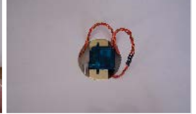
52. ...a celek vlepíme do křídla (páka je otočena k odtokovce) ... glue whole servo to wing (arm is turned to trailing edge).
