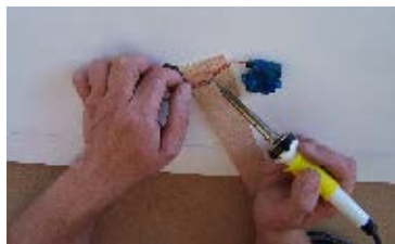
36. Ke kabelu připájíme kabel serva klapek (nezapomeneme na bužírku), povrch folie chráníme proti propálení Solder flap servo cable (do not forgot put tubes on the cables), you must protect surface of the foil before burn-out.
