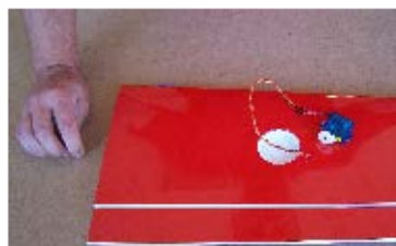
42. Pomocí drátu kabel protáhneme křídlem... Pass cable through wing, use bend wire ...
