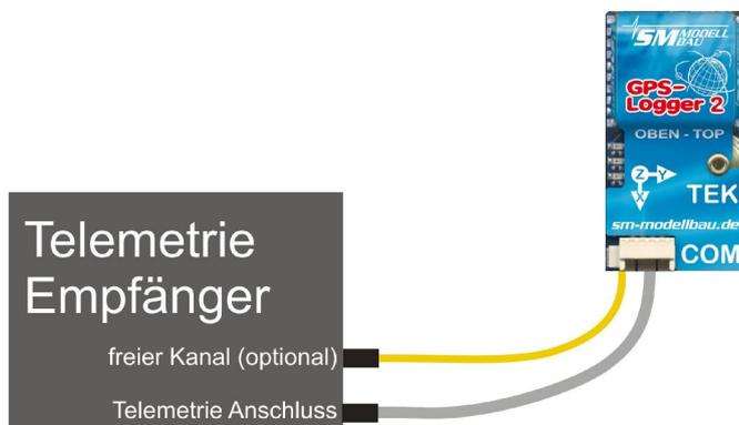
Der **GPS-Logger 2** wird direkt am Telemetrieanschluss angeschlossen.
