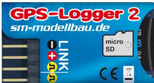
Die Karte wird in den Ausschnitt auf der Rückseite eingeschoben bis sie mit der Platine bündig ist. Der **GPS-Logger 2** hat keinen Auswurf für die Speicherkarte, sie wird einfach mit dem Finger wieder heraus gezogen. Bei Bedarf hilft hier auch ein kleiner Streifen Klebeband
