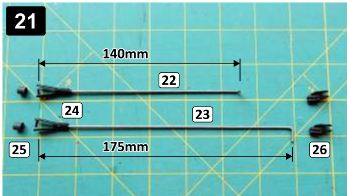
21 Sestavte táhla směrovky a výškovky. Na táhlo (22, 23) našroubujte vidličku (24). Délku táhla nastavte na 140mm (směrovka) a 175mm (výškovka). Complete the rudder and elevator pushrods. Screw the rod (22, 23) into the rod end (24). Set length of the pushrod 140mm (rudder) and 175mm (elevator).
