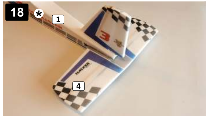
18 * Výškovku (4) zasuňte do výřezu v trupu (1). Trup přitom mírně roztáhněte. Dbejte, aby byla výškovka v trupu přesně usazena. Insert the elevator (4) into the slot in fuselage (1). Stretch apart a little the fuselage during inserting the elevator (4). Insert the elevator to the right position.
