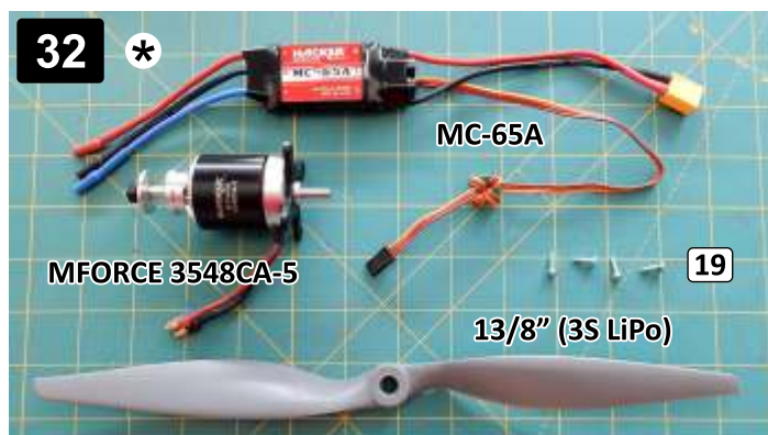
Připravte si pohonnou jednotku (motor, regulátor). Motor připravte na tzv. „zadní montáž“. Pokud si konektory na motor a regulátor letujete sami pracujte pečlivě a kvalitně. Při letování konektoru baterie k regulátoru dbejte na správnou polaritu. Prepare the power set (motor, speed controller). Motor will be mounted in front of the firewall. If do you solder the connectors on the motor and speed controller by your own make it carefully and well. Solder the battery connector to the speed controller with the correct polarity.
