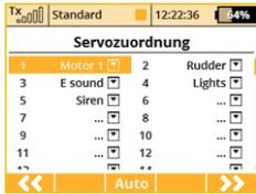
7. Zuordnung der Sender-Ausgangsfunktionen zu den Empfängerkanälen (Ausgängen). Haben wir im vorhergehenden Menü die Funktionen in der Reihenfolge erstellt, in der sie an den Empfängeranschlüssen erscheinen sollen, müssen wir diese Konfiguration nicht weiter umstellen. Bestätigen Sie mit der Taste „F5(>>)“.
