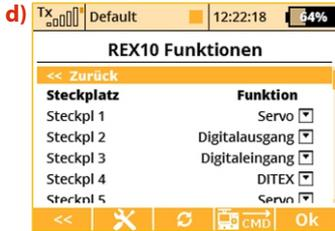
Telemetrie übertragen, so dass sie weiter verarbeitet werden können (z.B. am Sender angezeigt und auf die SD-Karte des Senders gespeichert). Die Empfänger Stifte sind mit internen Pull-up-Widerständen ausgestattet. Um einen logischen Wert eines Signalgebers zu erkennen, reicht es den Signalkontakt des Empfängers mit Masse zu verbinden.
