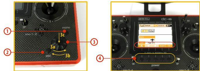
4. Die Funktionstasten („Softkeys“) unterhalb des Display „F1–F5“, werden je nach gewähltem Menü mit der jeweiligen Funktion in der unteren Bildschirmzeile beschriftet.
