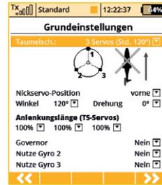
5. Wir wählen für den Hubschreiber in diesem Beispiel den Taumelscheibentyp „**3 Servos (Std. 120°)**“. Mit dem zweiten Parameter des Menüs „**Nickservo-Position**“ wird die Orientierung der Taumelscheibe um 180° gedreht. Der nächste Schritt ist die Bestätigung mit der Taste „**F5(>>)**“.
