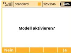
8. Der folgende Bildschirm fragt nun nach der Aktivierung des neu erstellten Modells. Bestätigen Sie diese Abfrage mit der Taste „F5(ja)“.
