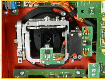
Wollen Sie eine **Rastwirkung**, ziehen Sie schrittweise die mit „**A**“ bezeichnete Einstellschraube der Rast-Bremse“ (im Uhrzeigersinn) bis zu dem Punkt an, bis bei Knüppelbewegung die Einzelschritte des Knüppels in gewünschter Stärke „**spürbar**“ werden. Lösen Sie die mit „**B**“ bezeichnete Einstellschraube der weichen Bremse“ (gegen den Uhrzeigersinn).
