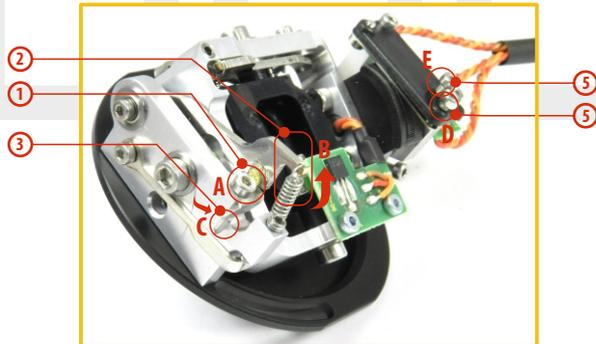
1. Lösen Sie Schraube **A**.
