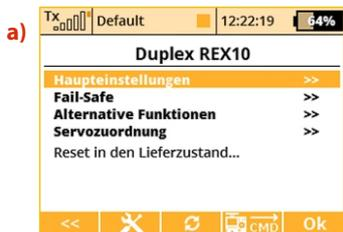
**Hinweis:** Bevor Geräte erkannt werden, ist eine spezielle vordefinierte Konfiguration / Ordnerstruktur auf der SD-Karte des Senders (im Ordner /Devices) vorhanden. Wird eine Fehlermeldung „Unbekanntes Gerät“ angezeigt, fehlt die passende Datei in diesem Ordner. Dann
