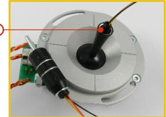
6. Lösen Sie das (geriffelte) Knüppeloberteil (durch Drehen entgegen dem Uhrzeigersinn)
