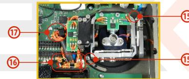
14. Stecken Sie das Knüppelaggregat zurück in den Sender.
