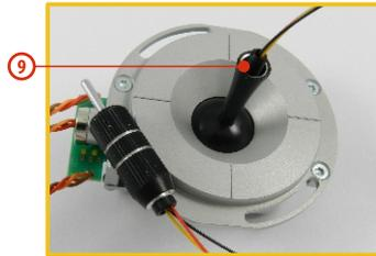
9. Führen Sie die Kabel des Schalters/Tasters durch die Öffnung im Steuerknüppel.
