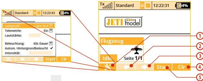
1. **Opt.** – Werkzeuge für direktes Sender Setup: Farbprofil, Telemetrie, Lautstärke, Dauer der Hintergrundbeleuchtung, Helligkeit
