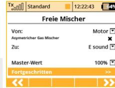
a). Mit der Taste „F2(+“) erstellen Sie einen freien Mischer. Im Parameter Von: – Mischereingang, wählen Sie „Motor“, und im Parameter „Zu:“ – Mischerausgang, geben Sie „E sound“ ein. Der Parameter „Master-Wert“ bestimmt die Übertragung vom Eingang zum Ausgang des Mixers. Mit der Taste „F5(-->)“ erstellen Sie den freien Mischer und wechseln zu deren Übersicht.
