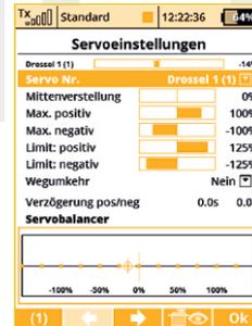
9. In diesem Menü werden die Einstellungen der einzelnen Servos an das Modell angepasst. Es können die Neutralstellungen, Wegbegrenzungen und -limits, Drehrichtungsumkehr, Verzögerungen usw. justiert werden. Mit den Tasten „F2“ und „F3“ werden schrittweise alle Einstellungen der einzelnen Servokanäle / Empfängerausgänge überprüft und angepasst.
