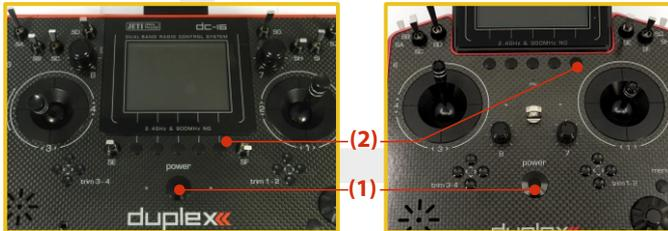
\* Wenn das Einschalten nicht bestätigt wird und das Zeitlimit verstreicht, schaltet sich der Sender automatisch wieder ab. In der Einstellung des Senders DC/DS kann das Einschalten über „HAUPTMENÜ -> Systemfunktionen -> Senderkonfiguration-> Startmeldung unterdrücken“ deaktiviert werden.
