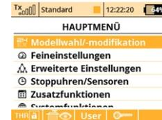
1. Schalten Sie den Sender ein und drücken die Taste „Menü“. Wählen Sie mit dem 3D Auswahlrads „Modellwahl/-modifikation“ und klicken diesen Punkt an.
