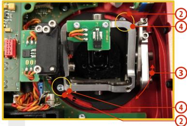
3. Drehen Sie das Knüppelaggregat in die gewünschte Lage.
