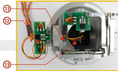
**Hinweis: Nach Einbau des Steuerknüppels mit Schalters / Taster ist die Längeneinstellung des Steuerknüppels nur dann möglich, wenn Sie die Sicherungsschraube lösen. Andernfalls könnten die Kabel des Schalters / Tasters abgedreht werden.**
