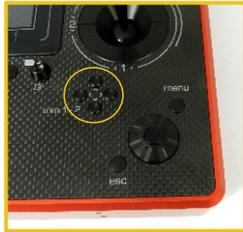
Die Trimmungen werden während des Fluges zur Feineinstellung der Fluglage verwendet. Die Einstellungen der Trimmungen werden automatisch so gespeichert, dass beim Abschalten und Wiedereinschalten des Senders die Trimmwerte beibehalten werden.
