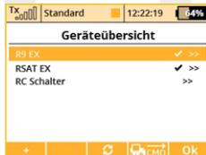
Das Hauptfenster der Geräteübersicht zeigt die registrierten Geräte (Empfänger/Sensoren...). Diese Geräte werden mit ihrem Namen oder ihrer Geräte-ID angegeben. Das OK-Häkchen hinter dem entsprechendem Gerät zeigt
