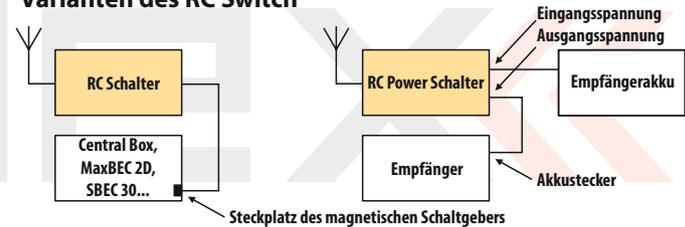
Die entsprechenden Einstellungen zum **RC-Ein/Aus** Schalter (**RC-switch**) finden Sie unter **Modellwahl/-modifikation->Geräteübersicht->RC-Switch**.
