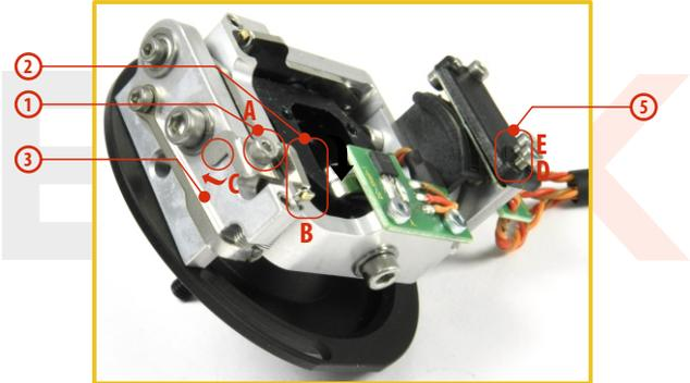
1. Lösen Sie Schraube **A**.
