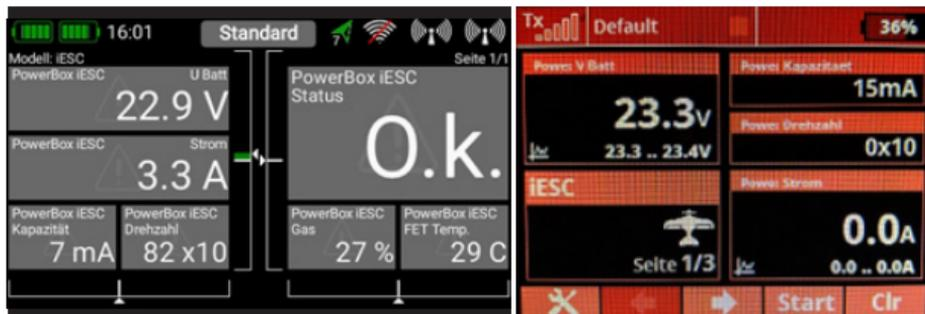
Beim **PowerBox** und Jeti System werden die verfügbaren Telemetrie-Werte wie gewünscht auf das Senderdisplay gelegt.
