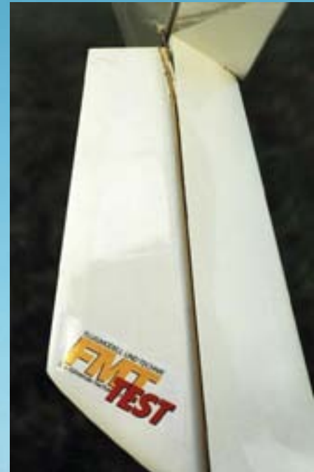
Ein Teil des Seitenruders muss ausgefräst werden, um der Höhenruderanlenkung Platz zu machen.
