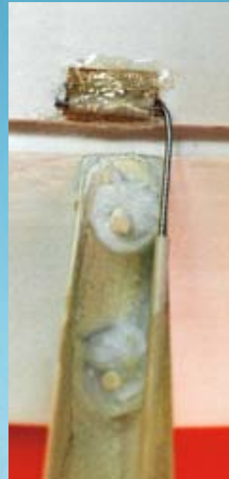
So will es der Hersteller: Anlenkungsdraht ins Bowden- zugröhrchen – natürlich mit Gewebe festzuharzen.
