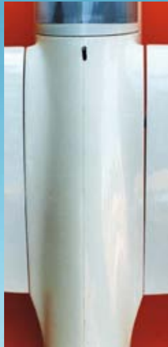
Nachhilfe: Die Tragflächen müssen noch angepasst werden (Harz-Microballon-Gemisch).
