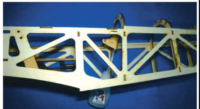
Mit Sekundenkleber befestigen Sie F20.
