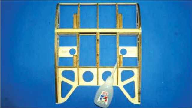
Mit Sekundenkleber befestigen Sie W9, W13 und W11.
