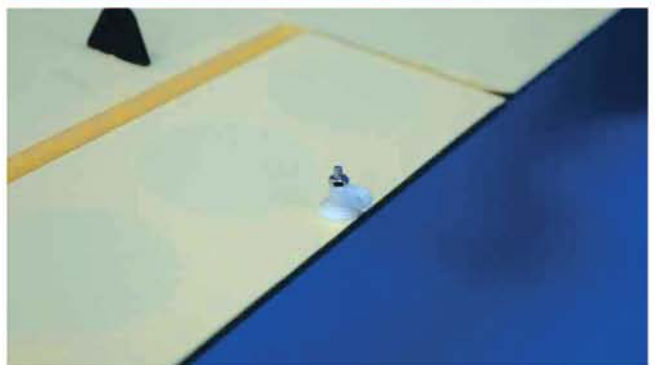
Befestigen Sie das Ruderhorn am Querruder des oberen Flügels.
