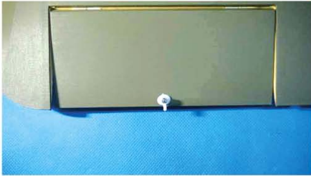
Befestigen Sie das Ruderhorn am Querruder des zweiten Flügels.
