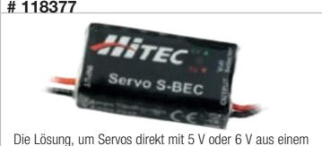
Die Lösung, um Servos direkt mit 5 V oder 6 V aus einem 2 - 6 zelligen LiPo zu versorgen!
