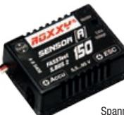
Die Tankuhr für den Akku. Dieser ROXXY Sensor ist für FASSTest-Telemetriesender, sowie die passende Telemetry-Box geeignet. Der Sensor führt eine potentialfreie Messung des Laststroms und der Spannung des Antriebsakkus durch. Die entnommene Stromstärke, Kapazität, sowie die
